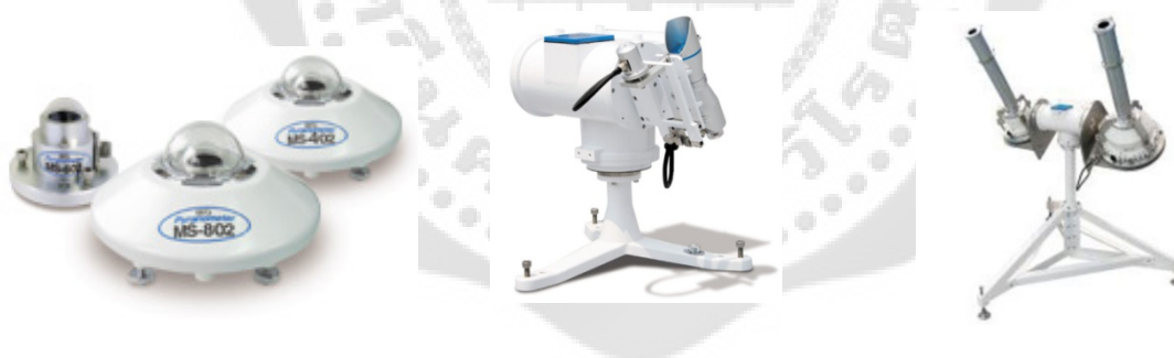
ภาพประกอบ 11 เครื่องมือวัดการแผ่รังสีดวงอาทิตย์
