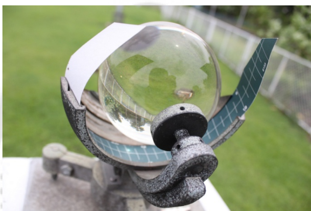
ภาพประกอบ 13 เครื่องวัดความยาวนานแสงแดดแบบแคมป์เบลล์-สโตรกส์
