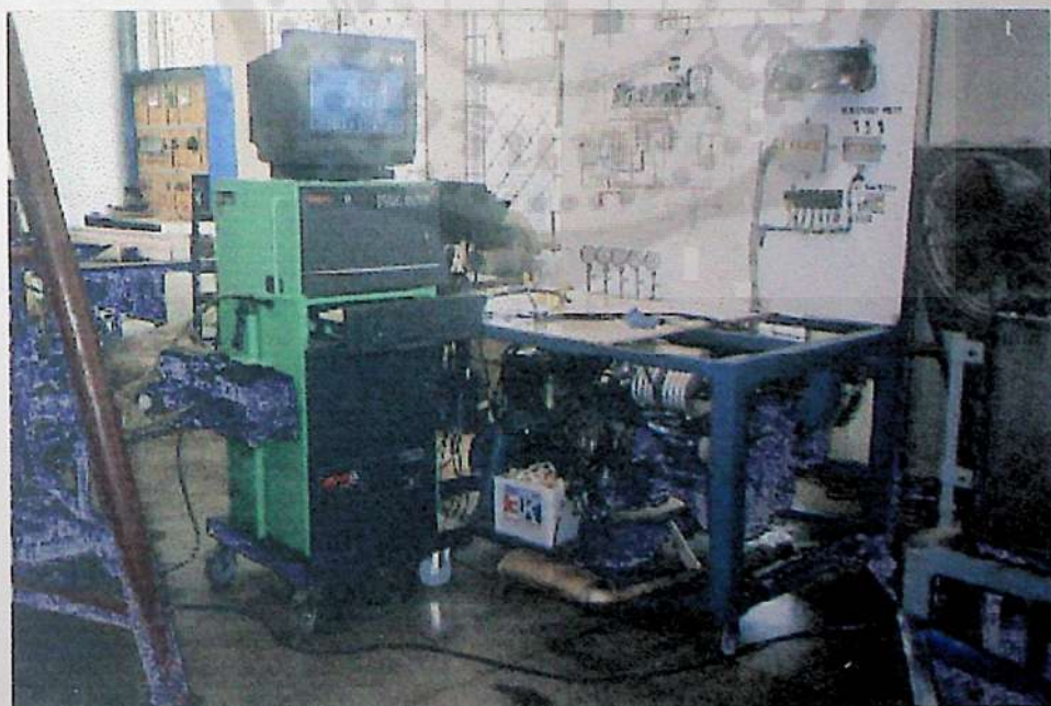
รูปภาพภาคผนวกที่ 4 แสดงการตรวจวัดก๊าซไอเสียขณะที่ติดตั้ง Catalytic Converter
