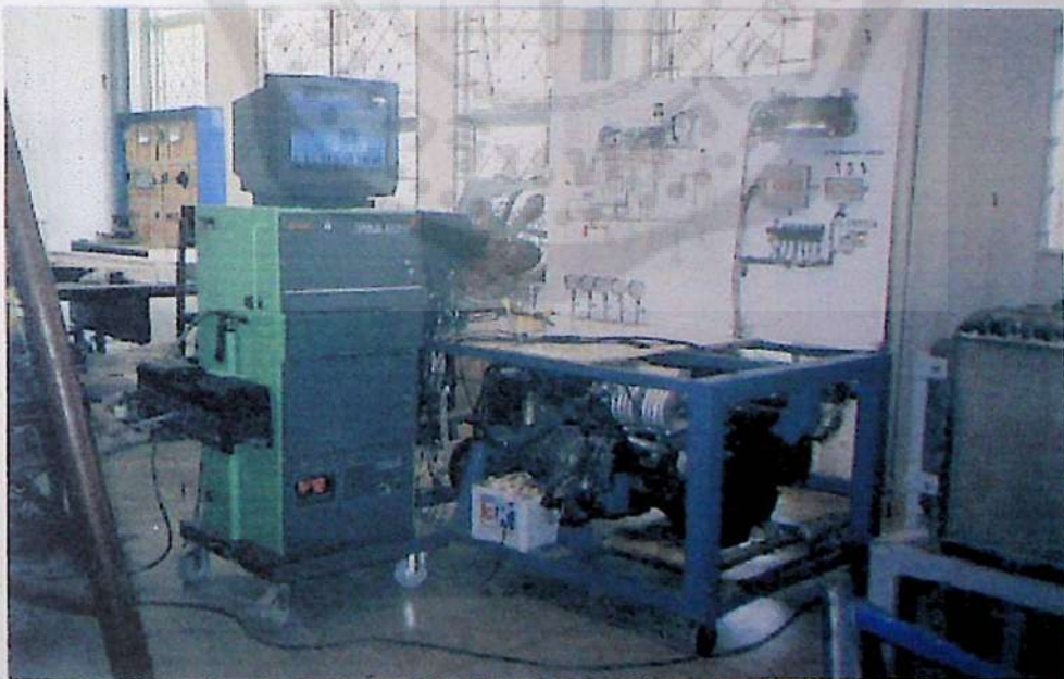
รูปภาพภาคผนวกที่ 2 แสดงการตรวจวัดก๊าซไอเสียขณะที่ไม่ได้ติดตั้ง Catalytic Converter
