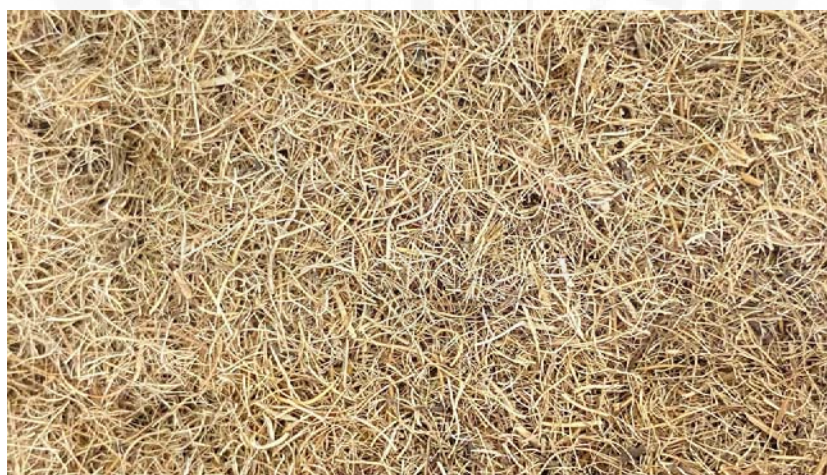
รูปภาพผนวก 6 แสดงเส้นใยปาล์มที่ผ่านการอบและตัดบดแล้ว
