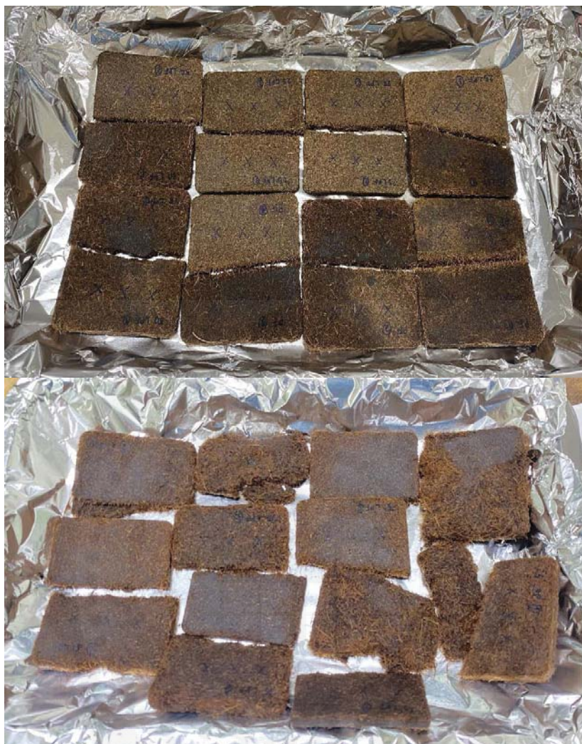
รูปภาพผนวก 9 แสดงตัวอย่างหลังแช่น้ำเป็นเวลา 1 ชั่วโมง และซับน้ำออกทิ้งไว้อีก 1 ชั่วโมง
