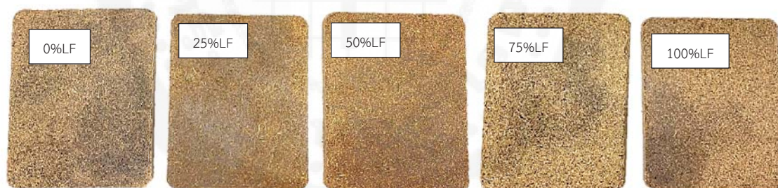
รูปที่ 16 ปาติเกิ้ลบอร์ดจากใยปาล์มที่ใช้กาวลิกนินฟอร์มัลดีไฮด์ ที่สัดส่วนต่างๆเป็นตัวอย่าง
