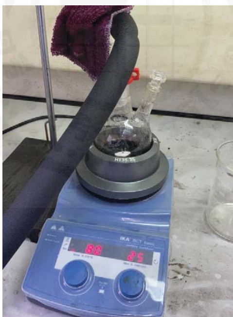
รูปที่ 13 แสดงการสังเคราะห์กาวลิกนินฟอร์มัลดีไฮด์
