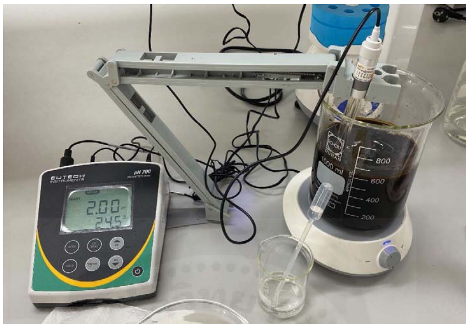
รูปภาคผนวก 5 แสดงการตักตะกอนลิกนินด้วยกรดไฮโดรคลอริก
