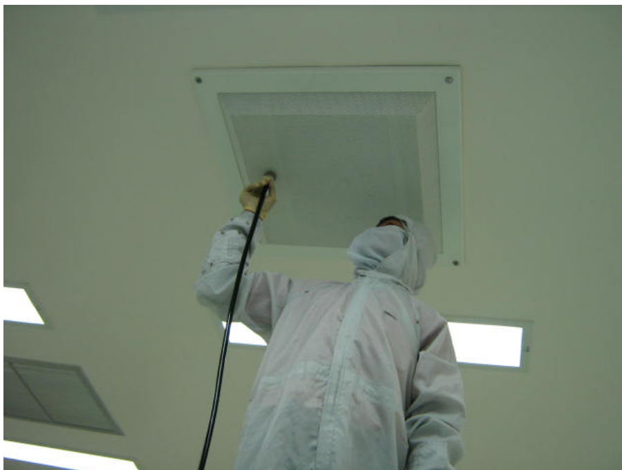
ภาพประกอบ 32 การตรวจหารอยรั่วของ HEPA FILTER
