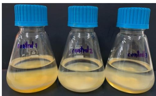
ภาพประกอบ 3.5 : แช่แบคทีเรียลเซลลูโลสในน้ำกลั่น
