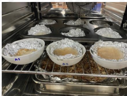
ภาพประกอบ 3.4 : การนำแบคทีเรียลเซลลูโลสเข้าอบ
