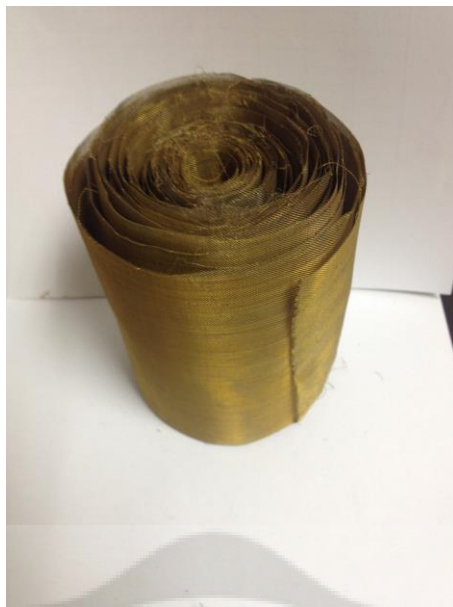
ภาพประกอบ 28 แสดงรีเจนเนอเรเตอร์ตะแกรงทองเหลือง 80 mesh ม้วนคล้ายกันหอย
