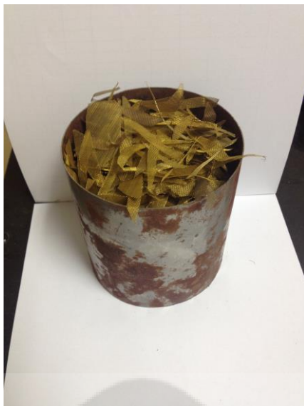
ภาพประกอบ 30 แสดงรีเจนเนอเรเตอร์ตะแกรงทองเหลือง 80 mesh ตัดเป็นเศษเล็กๆ
