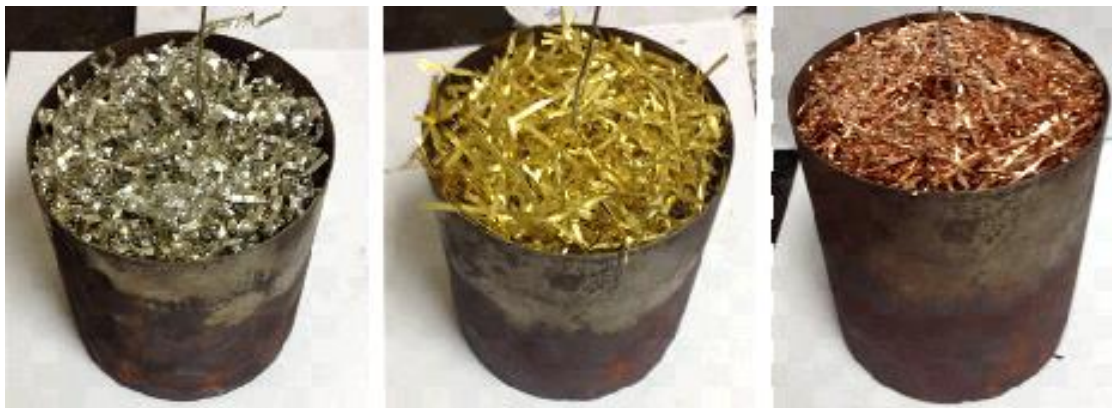
ภาพประกอบ 33 แสดงรีเจนเนอเรเตอร์ อะลูมิเนียม ทองเหลืองและทองแดง ตัดเป็นเส้น
