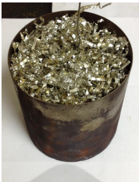
ภาพประกอบ 32 แสดงรีเจนเนอเรเตอร์ อลูมิเนียมตัดเป็นเส้นขนาดประมาณความกว้าง 2- 3 mm
