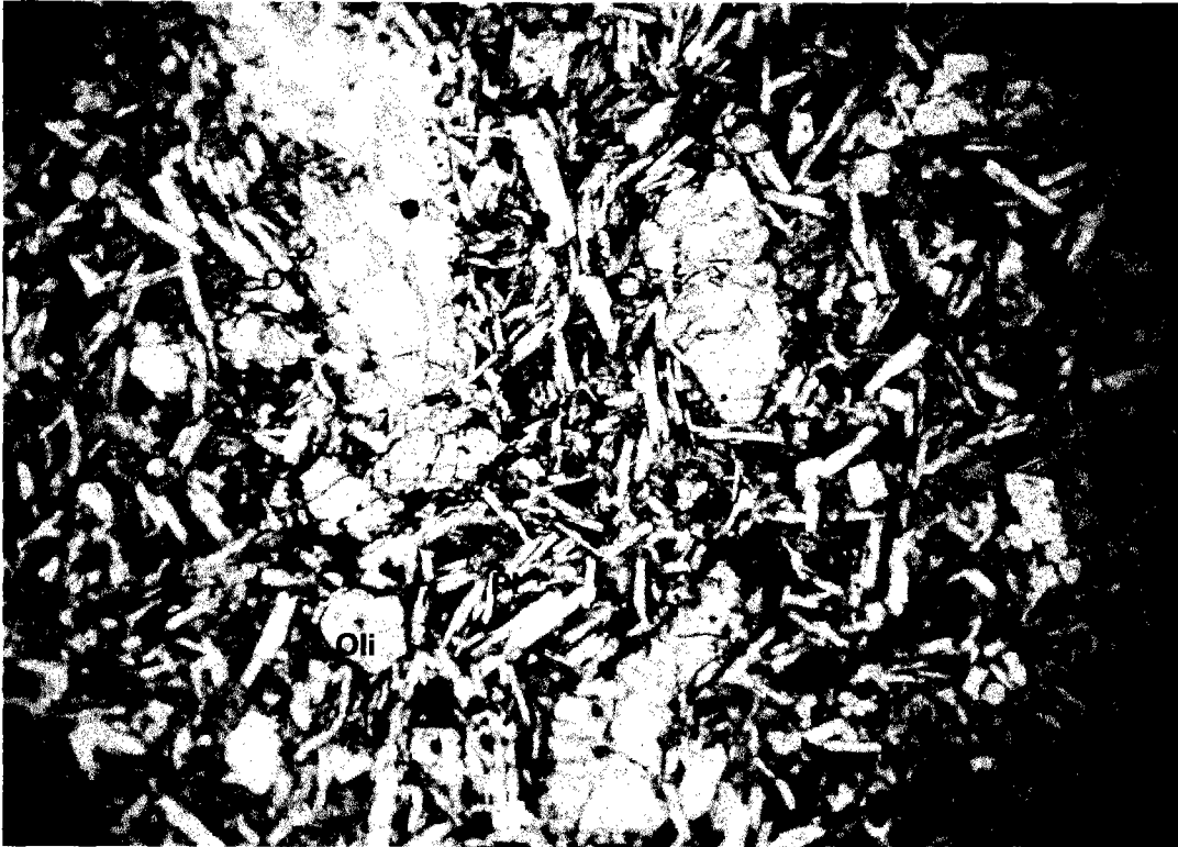
ภาพประกอบ 51 ผลึกแร่ในหินบะซอลต์ที่เขาน้อย มองผ่านกล้องจุลทรรศน์
