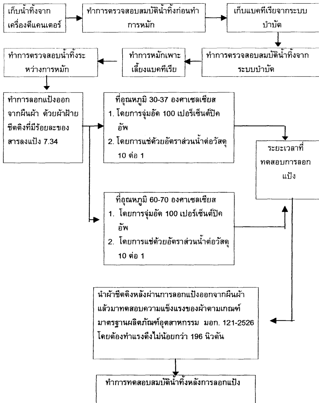
ภาพประกอบ 18 แสดงขั้นตอนการหมักและการลอกแป้งออกจากผืนผ้า
