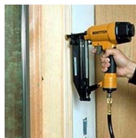
ภาพประกอบ 1 รูปลักษณะและลักษณะการใช้งานของเครื่องยิงตะปู
