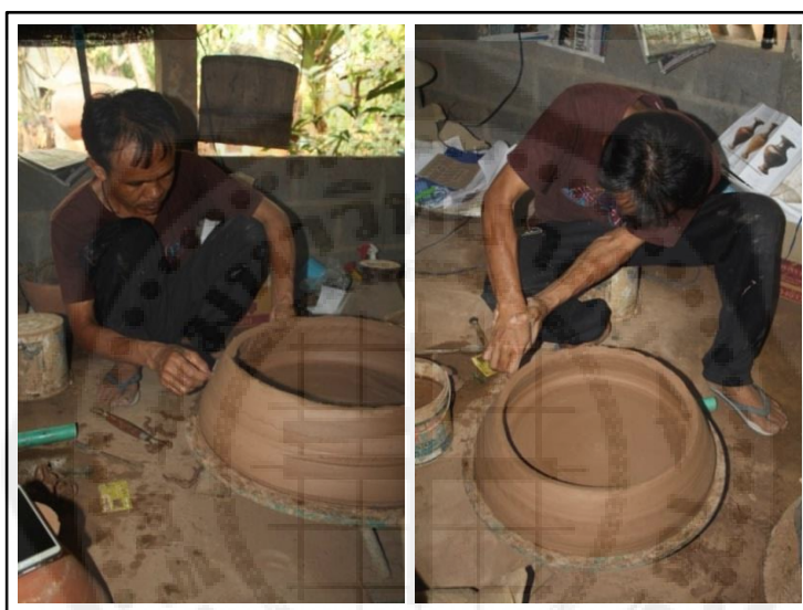
ภาพประกอบ 7 เมียน สิงห์ทะเล ช่างปั้นพื้นบ้าน กำลังขึ้นรูปงานบนแบนหมุน ในภาพเป็นแบนหมุนด้วยมือ
