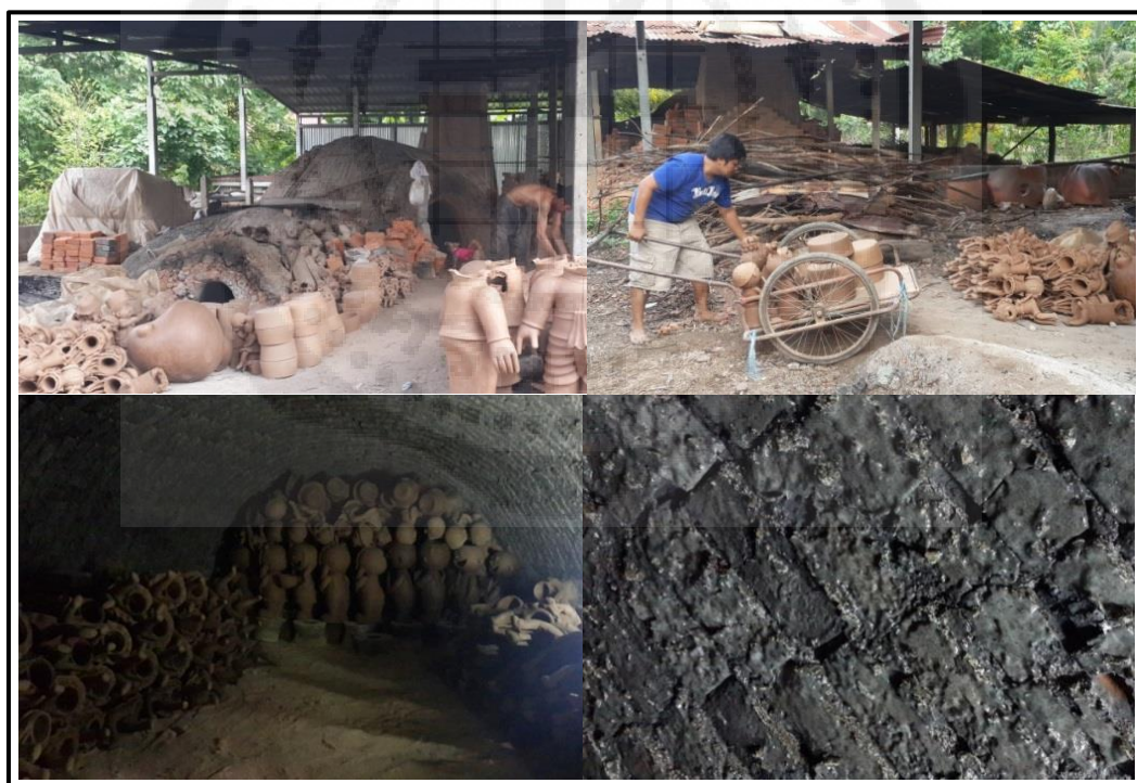
ภาพประกอบ 8 แสดงเตาก่อ การลำเลียงภาชนะเข้าเตา การเรียงงานในเตา และแสดงผลึกเคลือบที่เกิดขึ้นบนหลังคาเตา ภายในโรงงาน ของ มิตร สิงห์ทะเล
