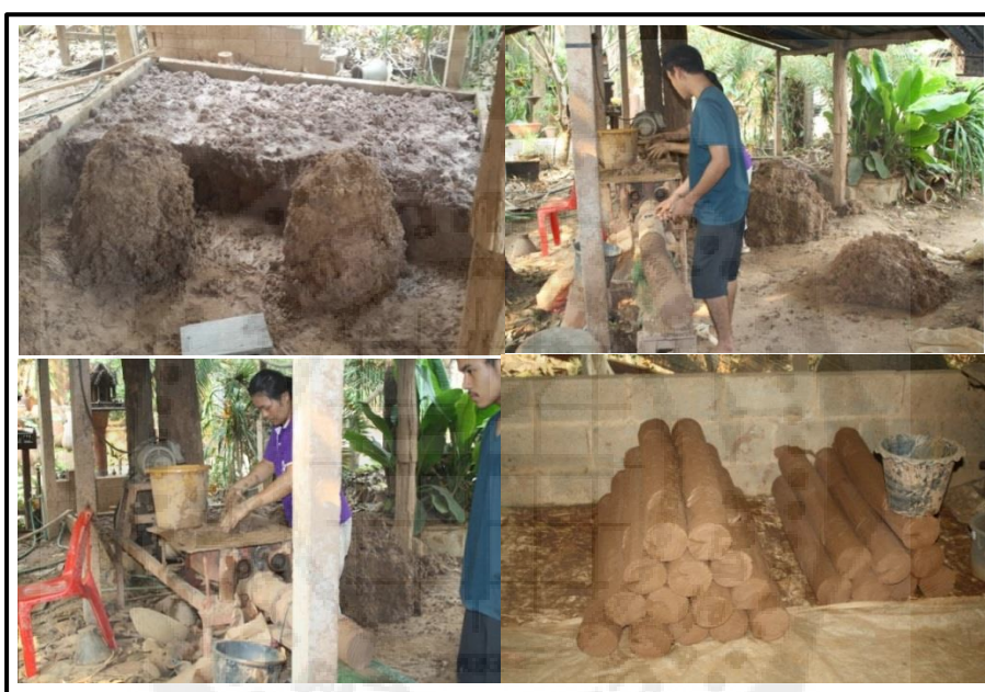
ภาพประกอบ 6 แสดงการหมักดินโดยการผสมดินกับทรายและแช่น้ำทิ้งไว้ และแสดงการนวดดินด้วยเครื่อง
