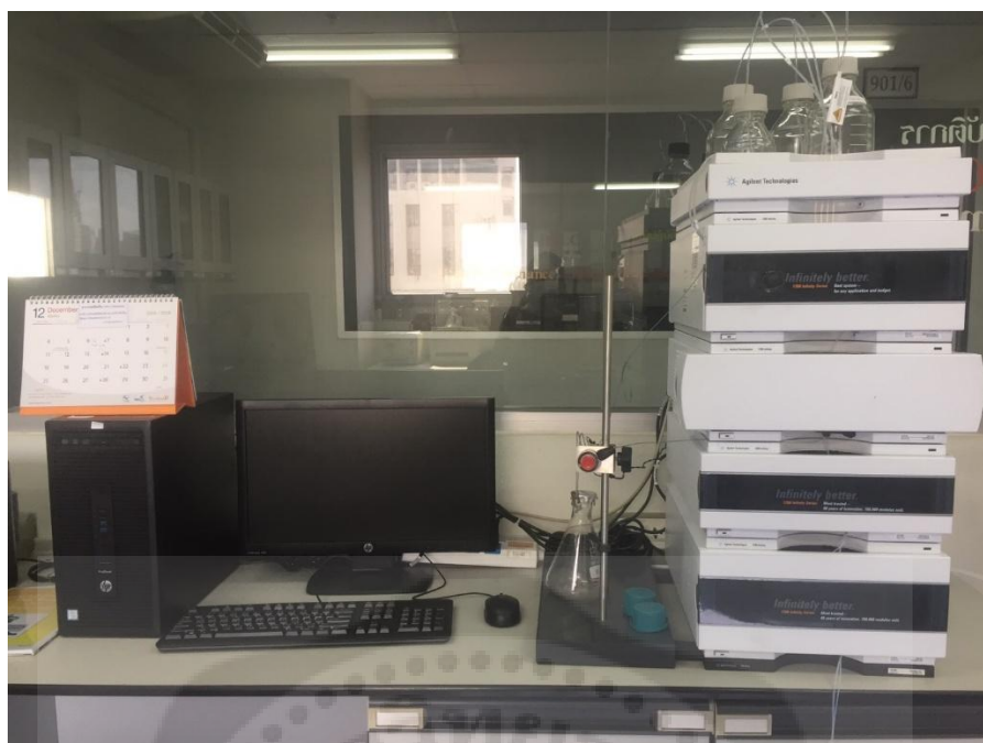
ภาพประกอบ 28 เครื่องโครมาโทกราฟีของเหลวสมรรถนะสูงและใช้ตัวตรวจวัดแบบไดโอดอาร์เรย์ (diode array detector) จากบริษัท Agilent Technologies รุ่น 1260
