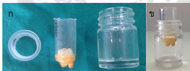
ภาพประกอบ 5 (ก) อุปกรณ์ที่ใช้ทำแบบจำลองการรั่วซึมของโปรตีน (ข) แสดงการประกอบแบบจำลองการรั่วซึมของโปรตีน
