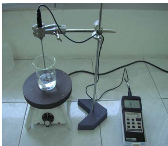
ภาพประกอบ 7 ชุดทดลองการวัดอุณหภูมิของสารละลายตัวอย่าง
