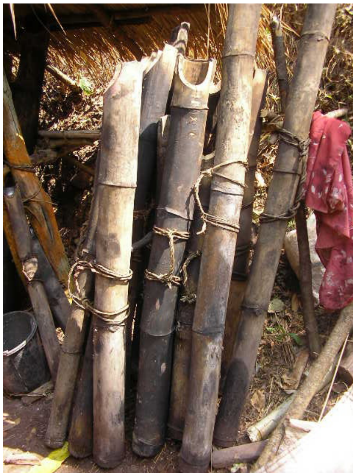
ภาพประกอบภาคผนวก 8 น้ำบั้ง (อุปกรณ์สำหรับใส่น้ำเกลือไปยังเตาต้มเกลือ)
