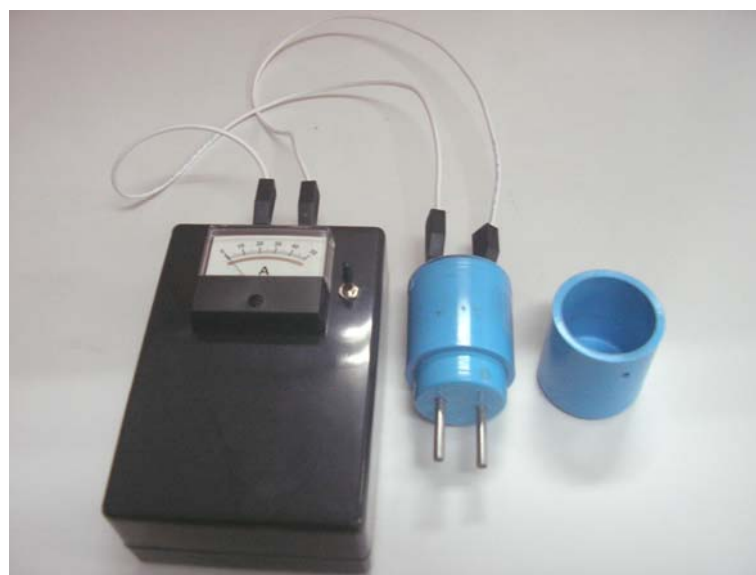
ภาพประกอบ 13 ออกแบบเครื่องมือวัดความเค็ม รุ่นเสริมเก่ง (SWU-NAN I)
