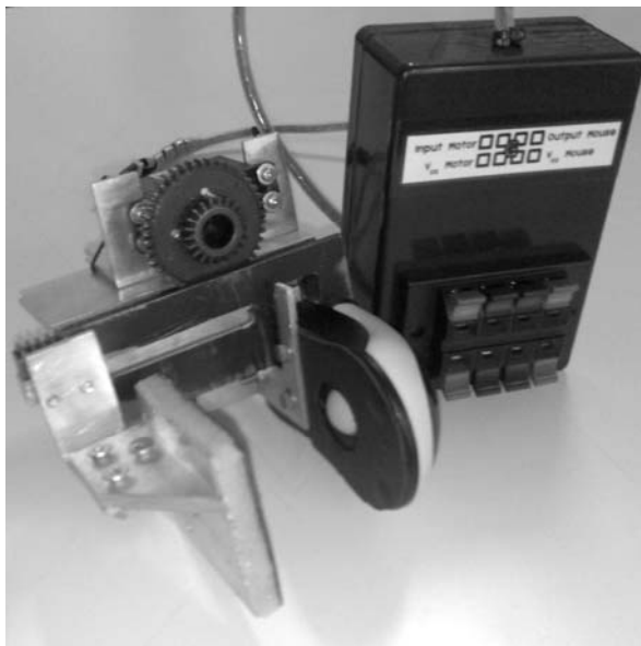
ภาพประกอบ 21 แสดงภาพของมือจับชิ้นงานที่ติดตั้งเมาส์ พร้อมกล่องรวมสายสัญญาณ
