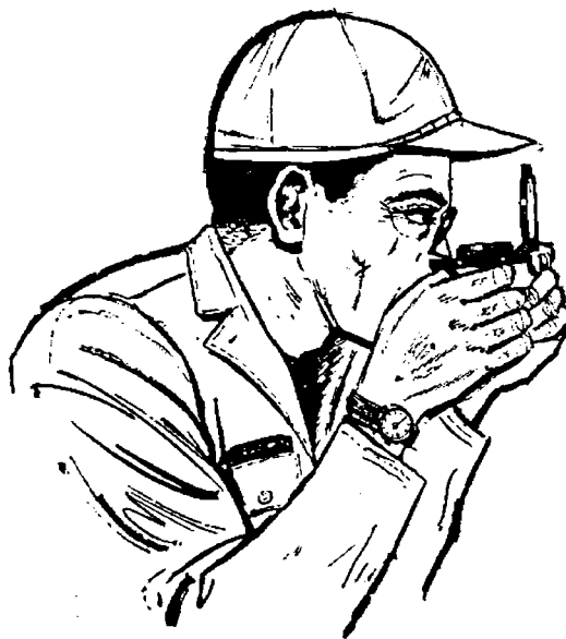
รูปที่ 5 - 2 Compass position for sighting
