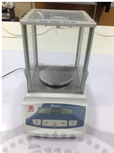
ภาพประกอบ 23 เครื่องชั่งน้ำหนักดิจิทัล ยี่ห้อ OHAUS รุ่น Pioneer PA413
