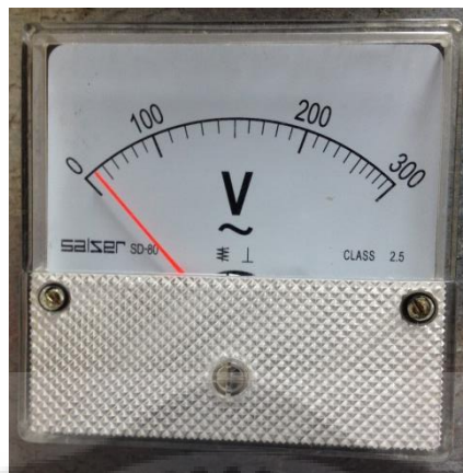
ภาพประกอบ 19 โวลท์มิเตอร์แบบเข็ม ยี่ห้อ SALZER รุ่น SD-80
