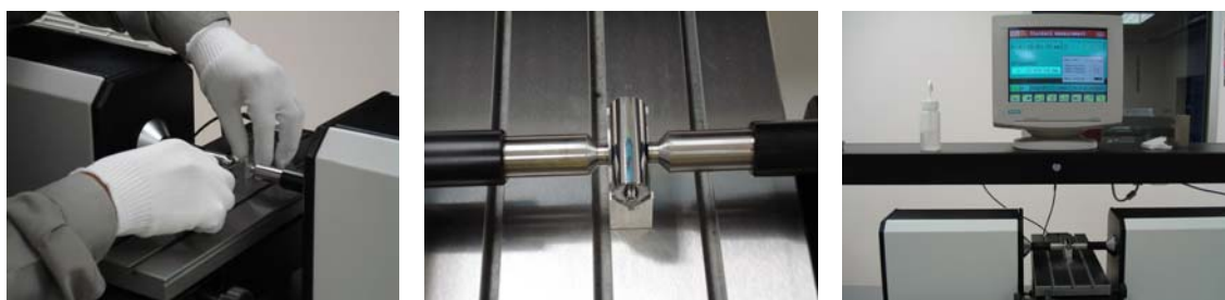
ภาพประกอบ 31 แสดงการวัดค่าเส้นผ่านศูนย์กลางของลูกสูบทดลอง
