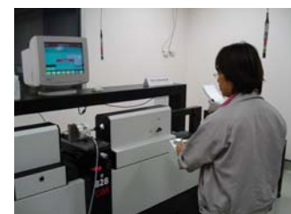
ภาพประกอบ 28 แสดงชุดของการติดตั้งโพลดเซลล์สำหรับการวัดแรง
