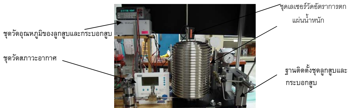
ภาพประกอบ 16 แสดงฐานติดตั้งชุดลูกสูบและกระบอกสูบทดลองและอุปกรณ์ต่างๆ
