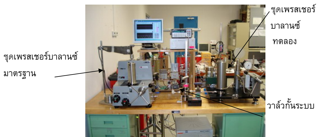
ภาพประกอบ 22 แสดงการติดตั้งชุดเพรสเซอร์บาลานซ์ของทั้งสองชุด
