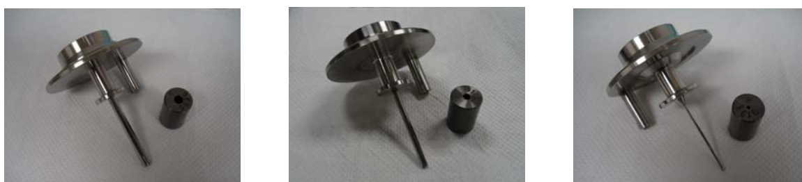
ภาพประกอบ 19 แสดงชุดลูกสูบและกระบอกสูบสำหรับเพรสเซอร์บาลานซ์มาตรฐาน
