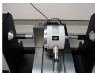
ภาพประกอบ 28 แสดงชุดของการติดตั้งโพลดเซลล์สำหรับการวัดแรง
