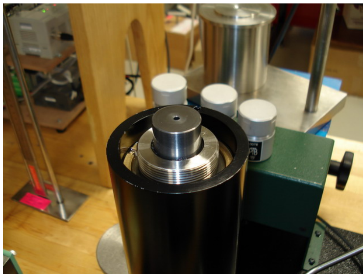
ภาพประกอบ 21 แสดงการประกอบชุดลูกสูบและกระบอกสูบเข้ากับฐาน
