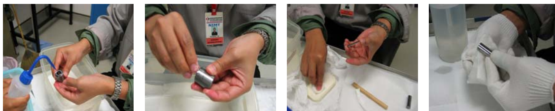
ภาพประกอบ 20 การทำความสะอาดชุดลูกสูบและกระบอกสูบทดลอง
