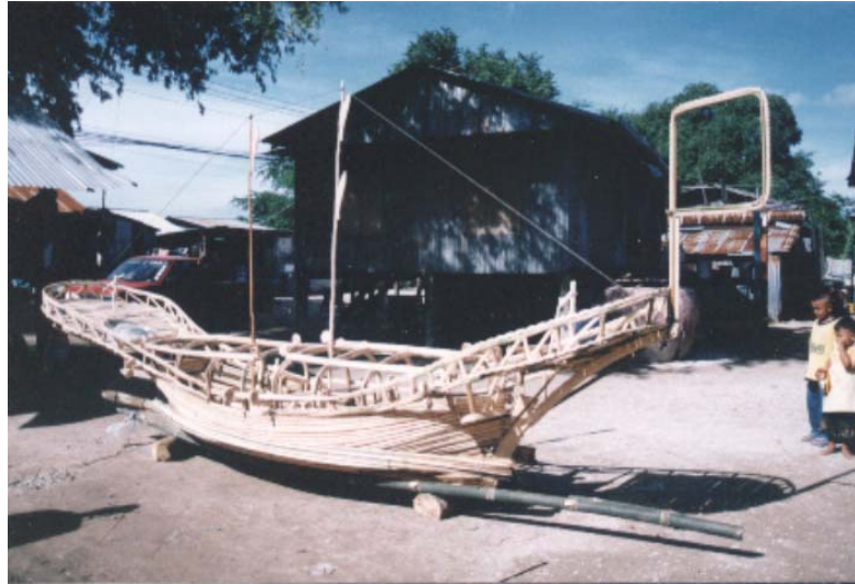
ภาพประกอบ 10 มาตรเรือ, โครงเรือ ใช้ไม้ทองหลาง และไม้ระกำ
