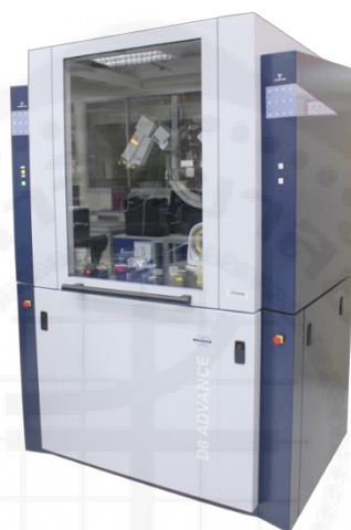
ภาพประกอบ 3.10 เครื่องวิเคราะห์การเลี้ยวเบนรังสีเอกซ์ หรือ X-ray Diffractometer (XRD)
