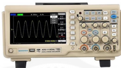
ภาพประกอบ 3.13 เครื่องออสซิลอโคป (Digital Oscilloscope)
