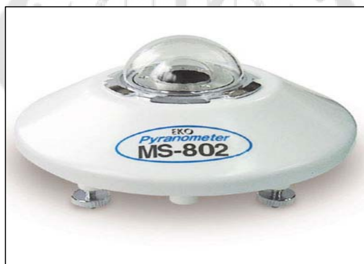
ภาพประกอบ 42 เครื่องไพรานอมิเตอร์ (Pyranometer) รุ่น MS-802 ที่ผลิตโดยบริษัทเอคโก (EKO)
