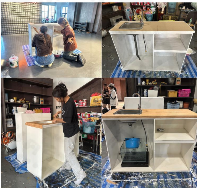
ภาพที่ 3.70: ภาพผู้ศึกษาและทีมดำเนินการผลิตเคาน์เตอร์ครัวที่เชื่อมต่อน้ำระบบวน
