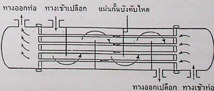
รูปที่ 2.3 แสดงอุปกรณ์แลกเปลี่ยนความร้อนแบบ Shell and tube
