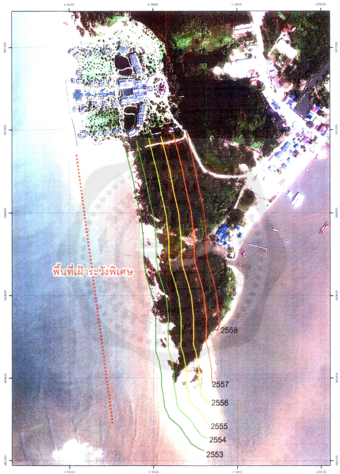
รูปที่ 4-10 แสดงขอบเขตแนวชายฝั่งที่คาดว่าจะเกิดการกัดเซาะ
