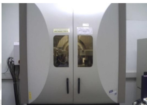
ภาพประกอบ 12 แสดงเครื่อง X-ray diffractometer รุ่น TTRAX III
