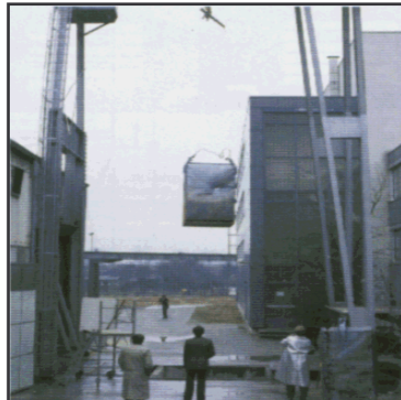
ภาพประกอบ 7 แสดงการทดสอบการตกกระแทก
