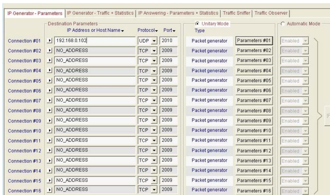
ภาพประกอบ ข-4 การตั้งค่า IP ปลายทางแบบ กรณี Single Point ของโปรโตคอล UDP สำหรับ เครื่องส่งข้อมูล
