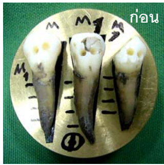
ภาพประกอบ18 ภาพถ่ายแสดงการติดยีสขึ้นงานตัวอย่างด้วยวัสดุประเภทกาวบน แท่นวางตัวอย่างก่อนและหลังการฉาบเคลือบด้วยทอง
