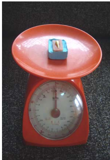
ภาพประกอบ 17 ภาพแสดงการยึดบล็อคอะคริลิกในบล็อคซิลิโคนที่ยึดติดอยู่บน เครื่องชั่งน้ำหนัก
