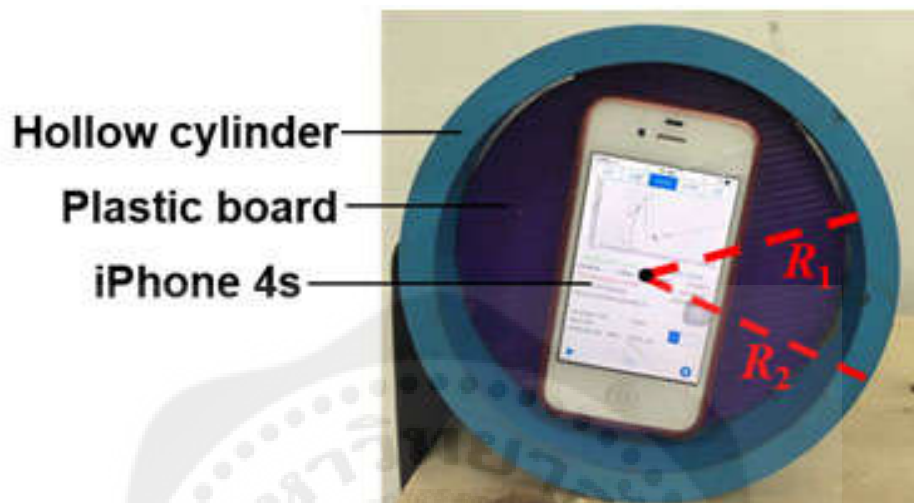
ภาพประกอบ 9 ทรงกระบอกกลวงติดกับแผ่นดิสก์พลาสติกบาง และสมาร์ทโฟน
