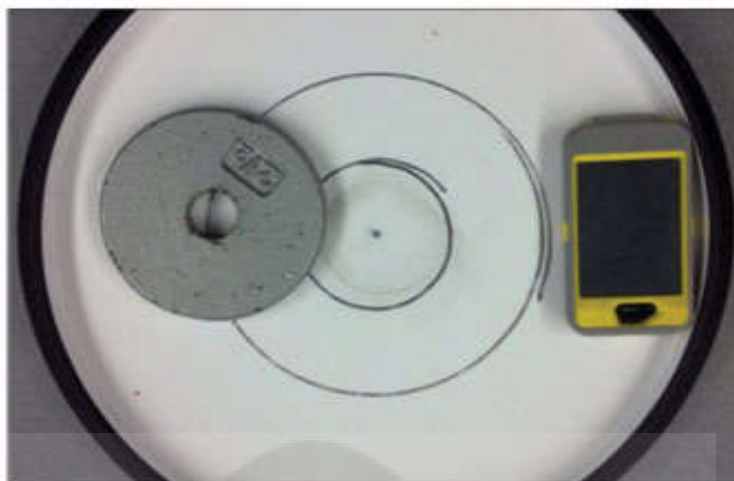
ภาพประกอบ 21 การติดตั้งชุดการทดลองเรื่องโมเมนตัมเชิงมุม
