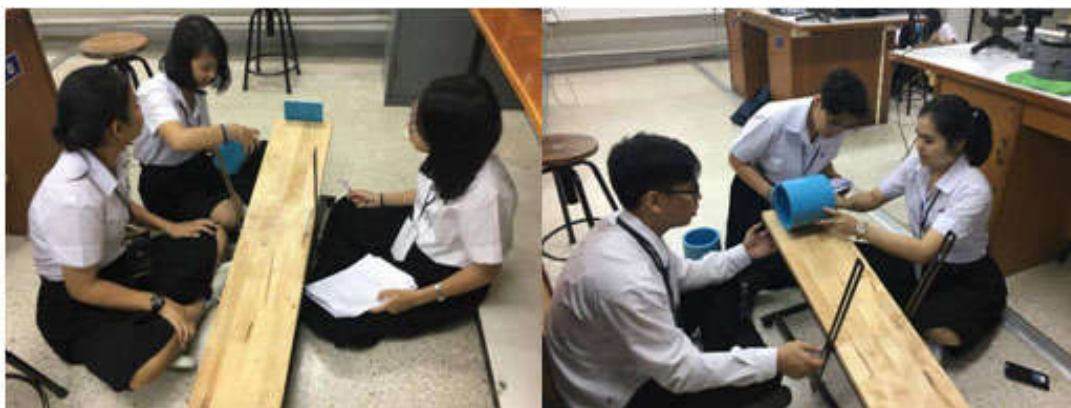
ภาพประกอบ 38 ผู้เรียนกลุ่มทดลองขณะทำการทดลองการเคลื่อนที่แบบกลิ้งบนพื้นเอียง
