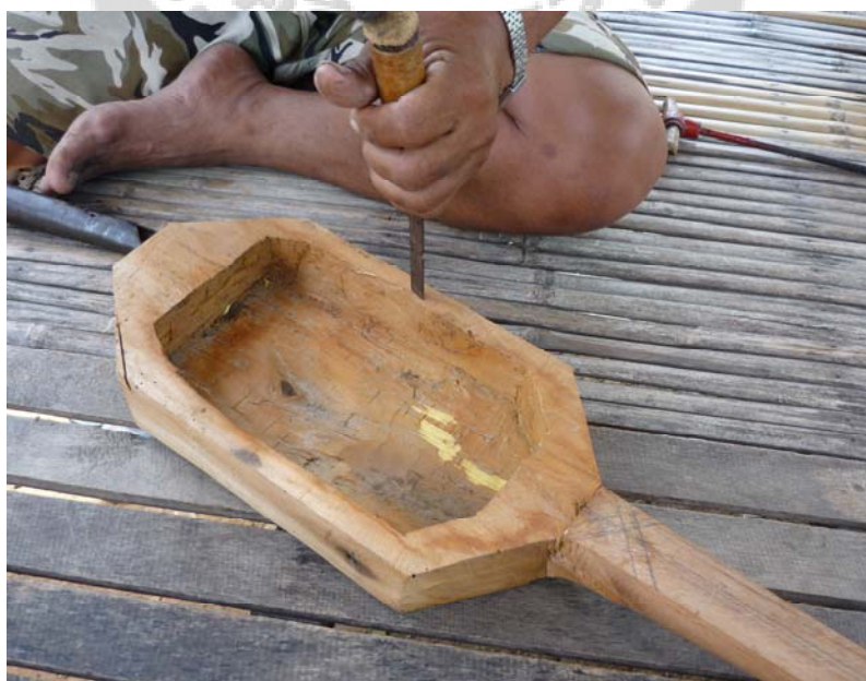
ภาพประกอบ 19 ขั้นตอนการเจาะช่องเสียงหรือกล่องเสียง
