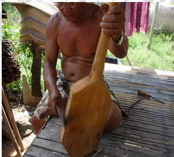
ภาพประกอบ 17 ขั้นตอนการเอาเนื้อไม้ออก โดยใช้มีดถากไม้
