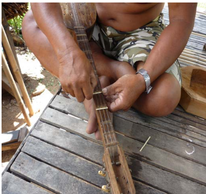
ภาพประกอบ 23 ขั้นตอนการติดชั้นเสียง
