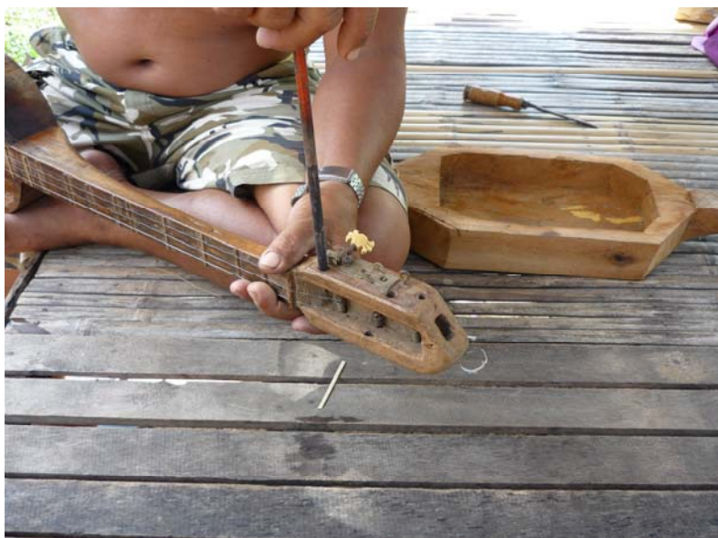
ภาพประกอบ 21 ขั้นตอนการเจาะรูลูกบิด
