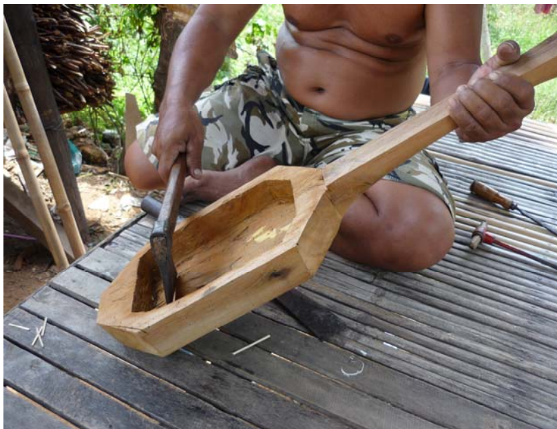
ภาพประกอบ 18 ขั้นตอนการเจาะช่องเสียงหรือกล่องเสียง เมื่อใช้มีดตากไม้เป็นรูปทรงพินเสร็จแล้ว ก็ใช้ขวานเล็กเจาะทำกล่องเสียง ดังรูป
