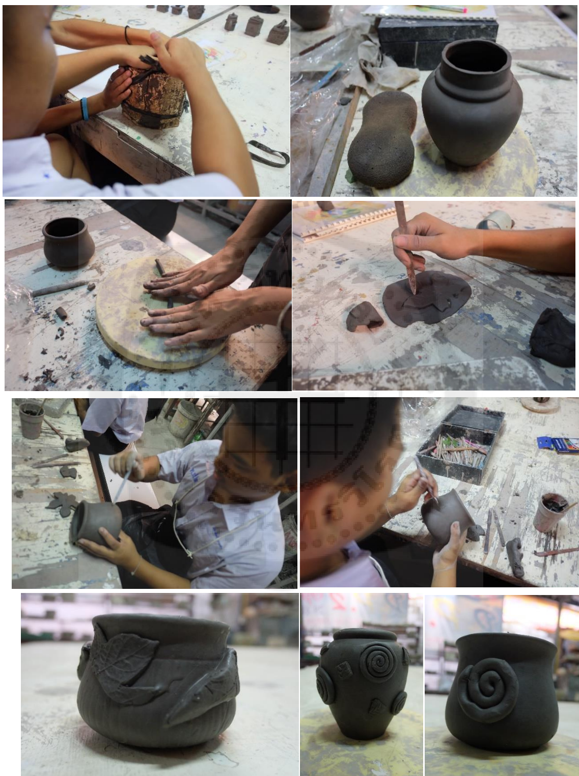
ภาพประกอบ 27 ภาพขั้นตอนการปฏิบัติงานขึ้นรูปวิธีหล่อ
