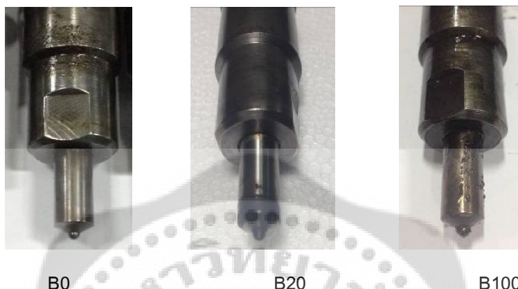
ภาพประกอบ 18 สภาพหัวฉีดที่ผ่านการใช้งานด้วยเชื้อเพลิง B0, B20, B100
