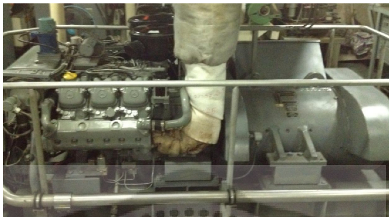
ภาพประกอบ 45 เครื่องยนต์ดีเซลกำเนิดไฟฟ้าเรือ
