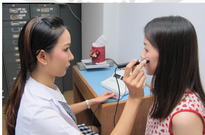
ภาพประกอบ 32 แสดงการวัดค่าความแดง (erythema index) ด้วย Mexameter® รุ่น MX 16
