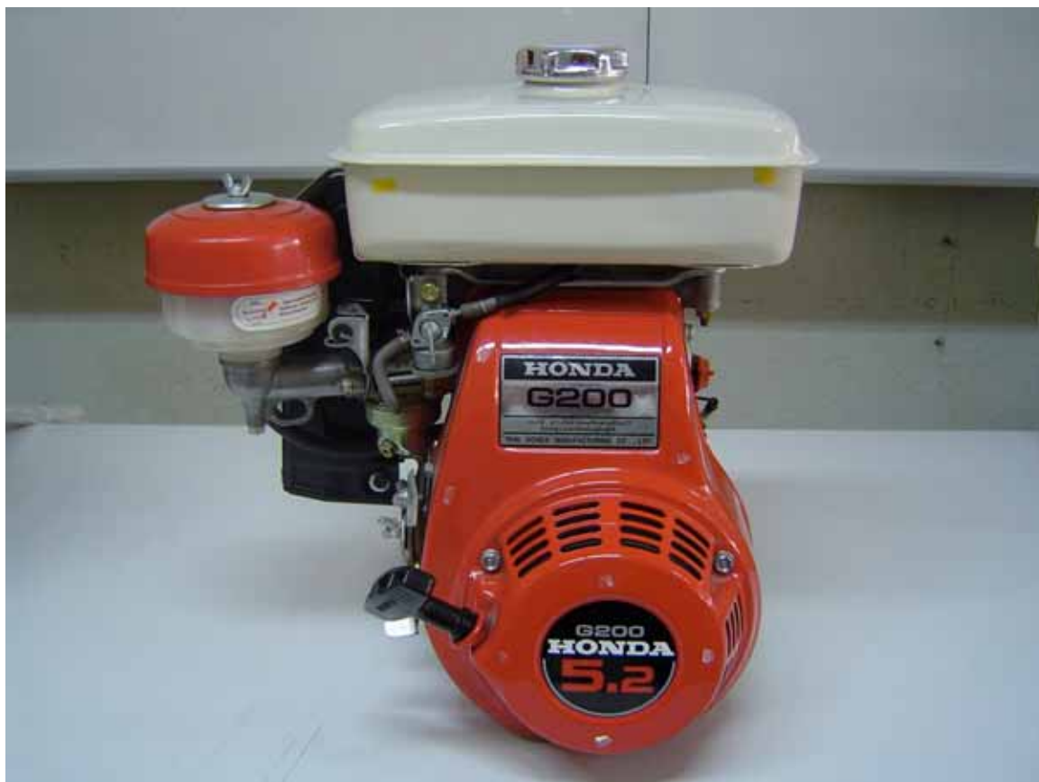
ภาพประกอบ 44 รูปเครื่องยนต์ก๊าซโซลีนสูบเดี่ยว ยี่ห้อ ฮอนด้า รุ่น G200
