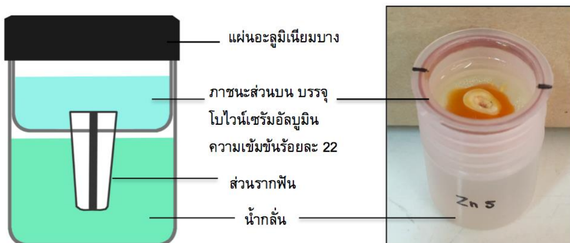
ภาพประกอบ 10 แบบจำลองการทดสอบการรั่วซึมของโปรตีน
