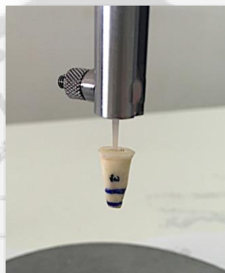
ภาพประกอบ 11 การใช้เครื่องสำรวจความขนานวัด รากฟันที่ได้รับการอุดแล้ว ก่อนทำการหล่อแบบด้วยเรซิน
