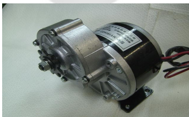
ภาพประกอบ 27 มอเตอร์ควบคุมการเคลื่อนที่แนวอัลติจูด
