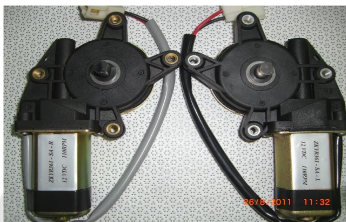
ภาพประกอบ 26 มอเตอร์ควบคุมการเคลื่อนที่แนวอะซิมุท
