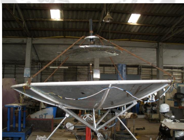
ภาพประกอบ 32 จานพาราโบลา 2 ขั้นตอนที่ประกอบด้วยจานพาราโบลาขนาดใหญ่และเล็ก
