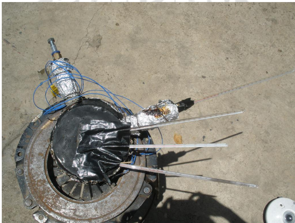
แคลอริมิเตอร์ที่ใช้ในการทดสอบทำจากทองแดงมีขนาด \phi 138 mm สูง 40 mm
