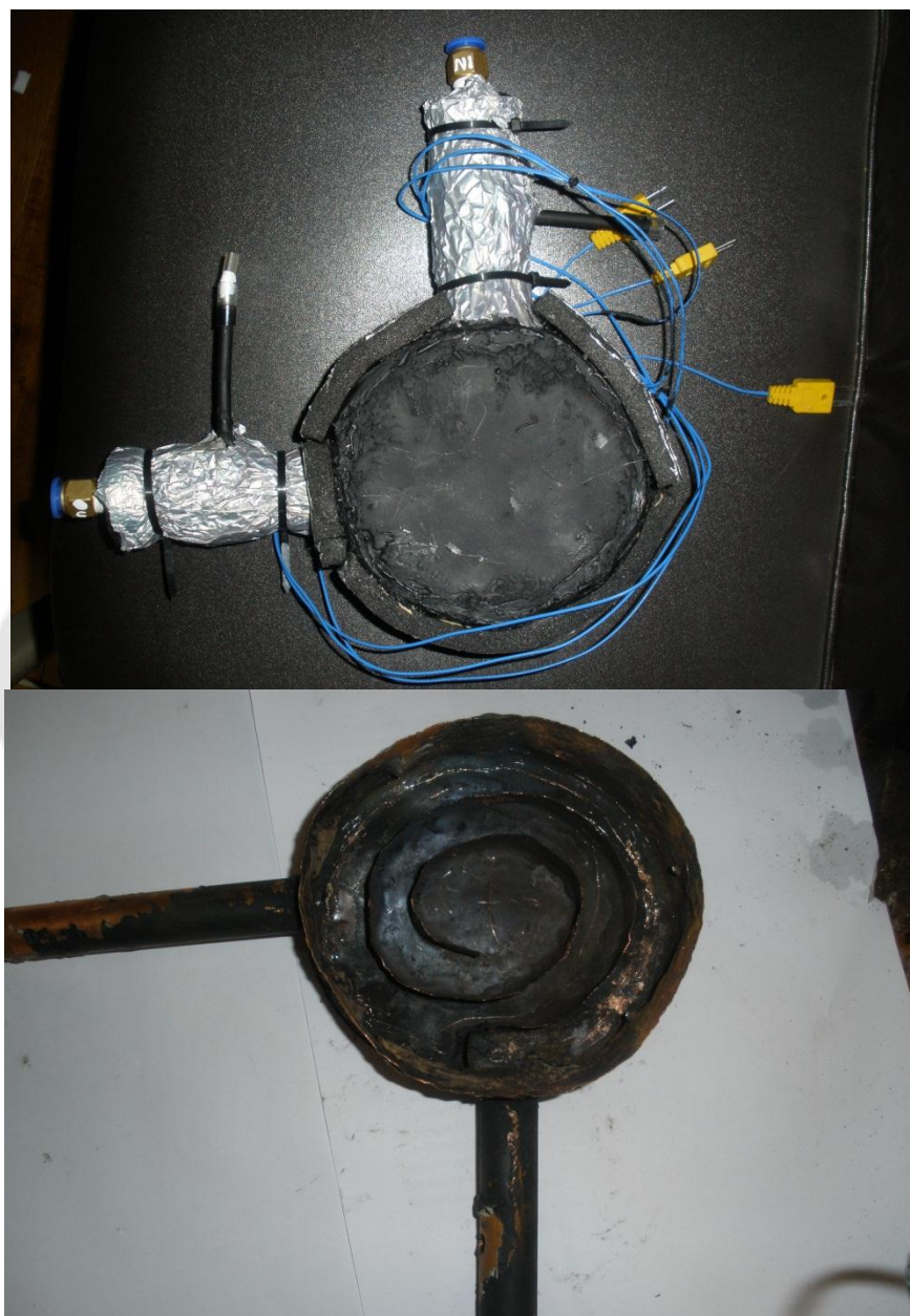
ภาพประกอบ 35 แคลอริมิเตอร์แบบก้นหอยเพื่อเพิ่มประสิทธิภาพในการถ่ายเทความร้อน
