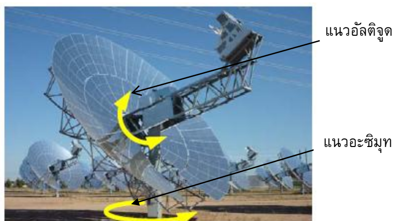
ภาพประกอบ 19 ส่วนเคลื่อนที่แนวอัลติจูดและแนวอะซิมุท
