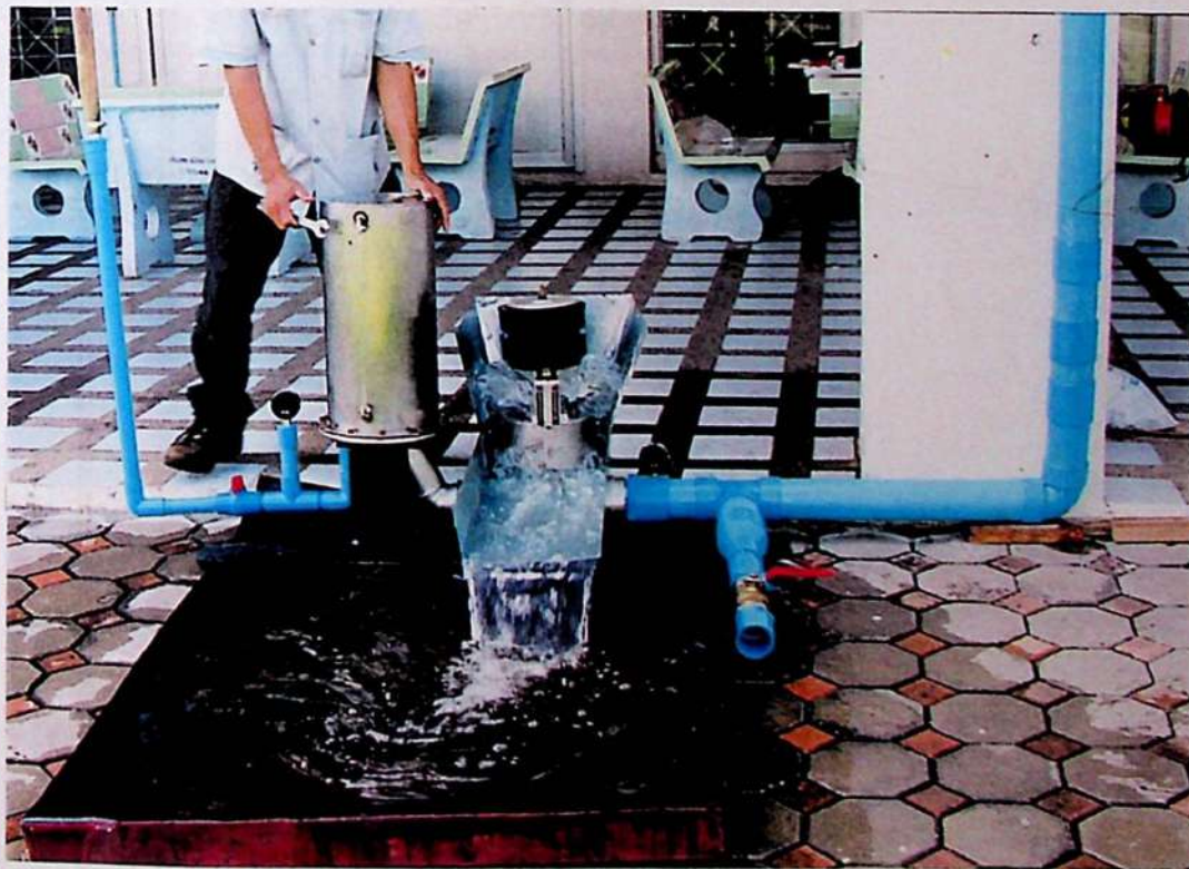
รูปที่ 4.5 แสดง Hydraulic Ram Pump ขณะทำงาน (ด้านหลัง)
