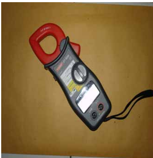
ภาพประกอบ18 เครื่องมือวัดกระแสไฟฟ้าและแรงเคลื่อนไฟฟ้าของคอมเพรสเซอร์
