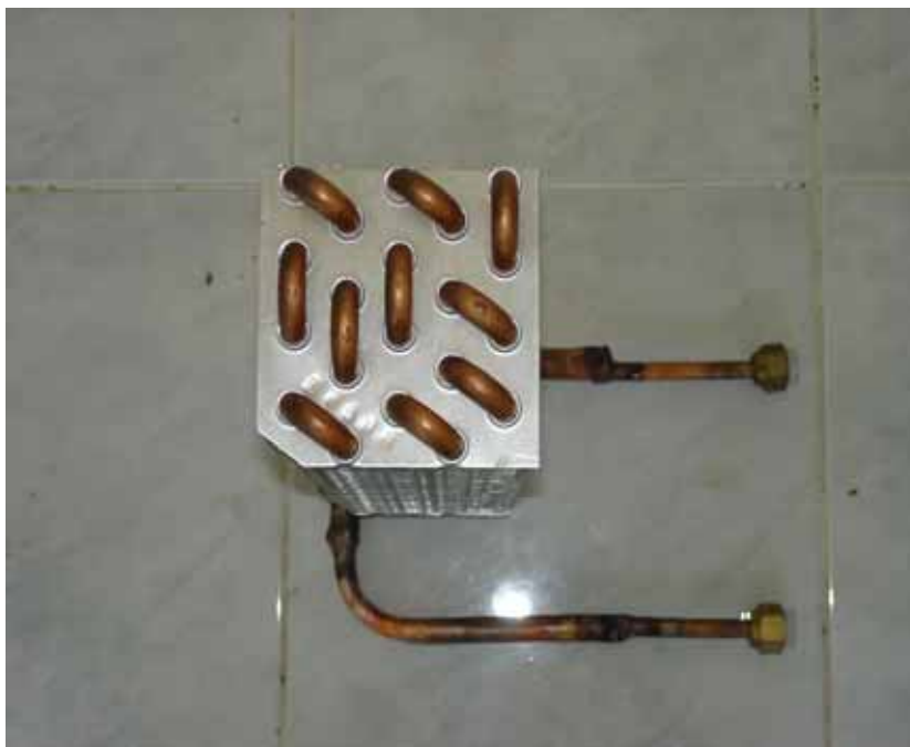
ภาพประกอบ 13 แสดงเครื่องแลกเปลี่ยนความร้อนที่เป็นท่อทองแดงกลมแบบมีครีบริบผิวเรียบ
