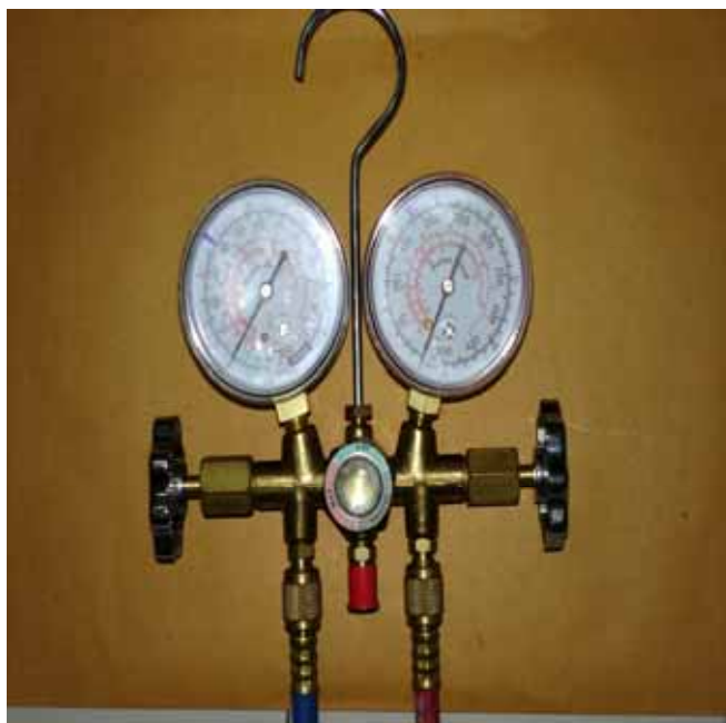
ภาพประกอบ 17 เครื่องมือวัดความดันสารทำความเย็นของเครื่องปรับอากาศ ด้านความดันต่ำ (Low pressure) และ ด้านความดันสูง (High pressure)
