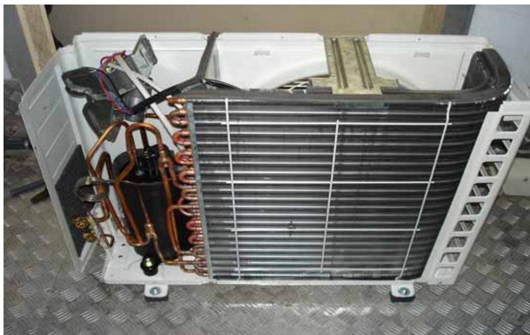
ภาพประกอบ 12 แสดงชุดคอนเดนซินังของเครื่องปรับอากาศ YORK รุ่น HGEDA12FS-AAT ขนาด 12000 Btu/hr
