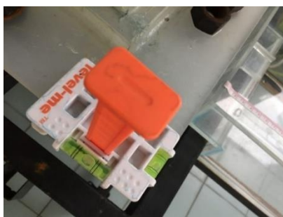
ภาพประกอบ 7 การติดตั้งระดับน้ำในชุดการทดลองทอริริเซลล์
