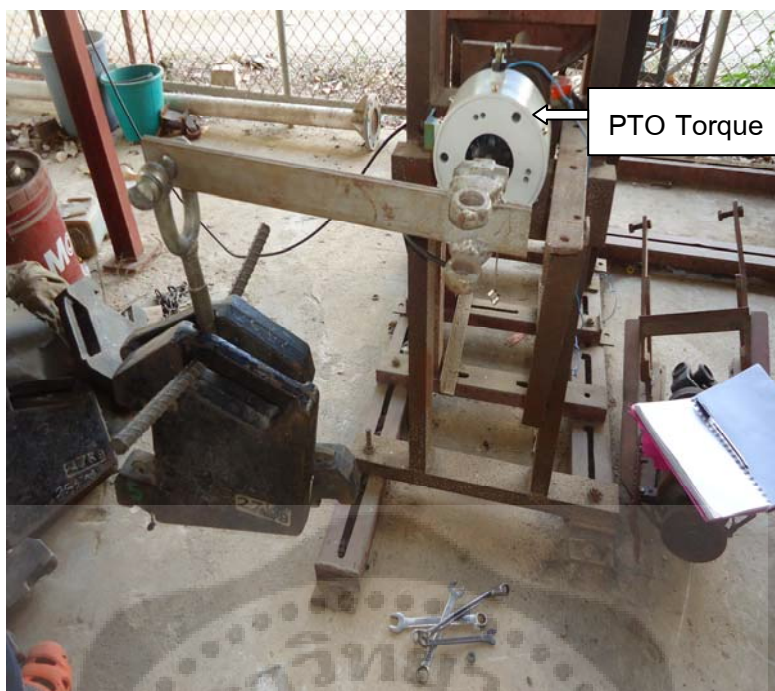
ภาพประกอบ ข3 การ Calibration Strain Gage ที่ติดตั้งบน PTO Torque
