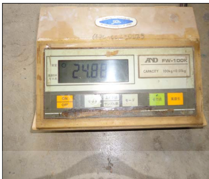
ภาพประกอบ 13 แสดงเครื่องชั่ง AND รุ่น FW-100K (ความละเอียด 0.01 กรัม)
