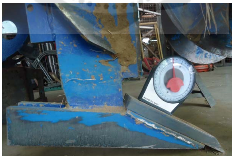
ภาพประกอบ 21 ชิ้นส่วน Subsoil opener ทำมุม 31 องศา
