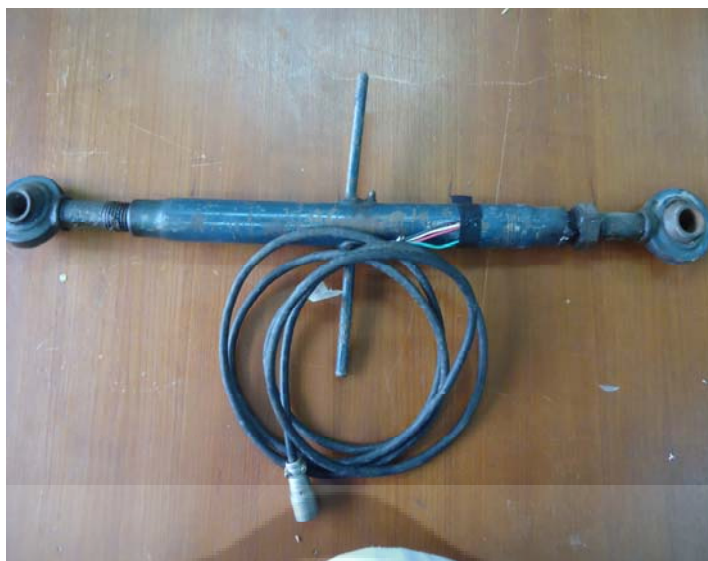
ภาพประกอบ 10 แสดง Top link transducer Wheatstone bridge Circuit Pass Bridge boxes
