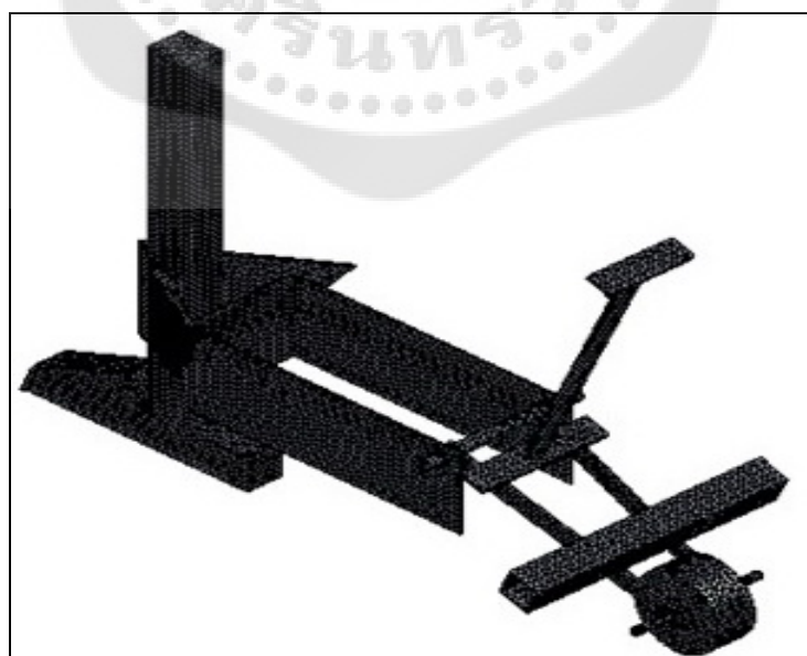
ภาพประกอบ 19 แสดงเอลิเมนต์แบบสามเหลี่ยมบนชุดเปิดหน้าดิน 3 มิติ
