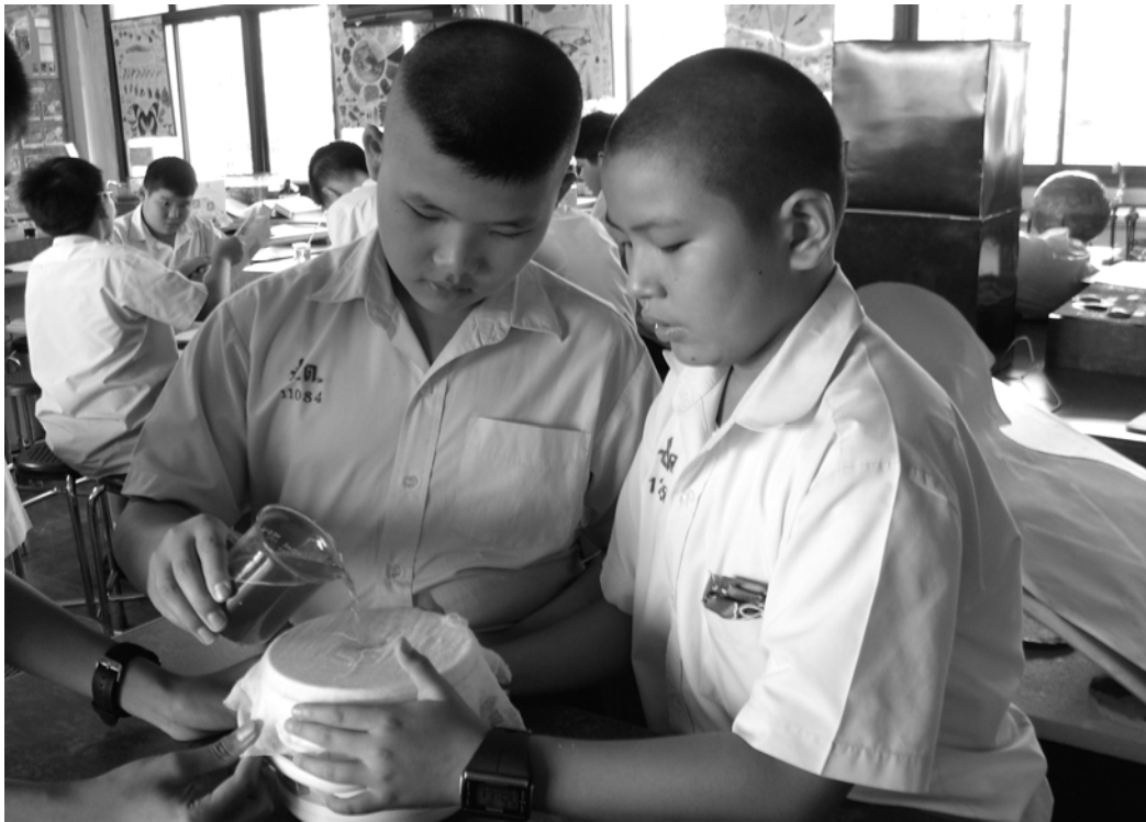
ภาพประกอบ 40 แสดงวิธีการกรองน้ำตัวอย่างด้วยผ้าขาวบาง
