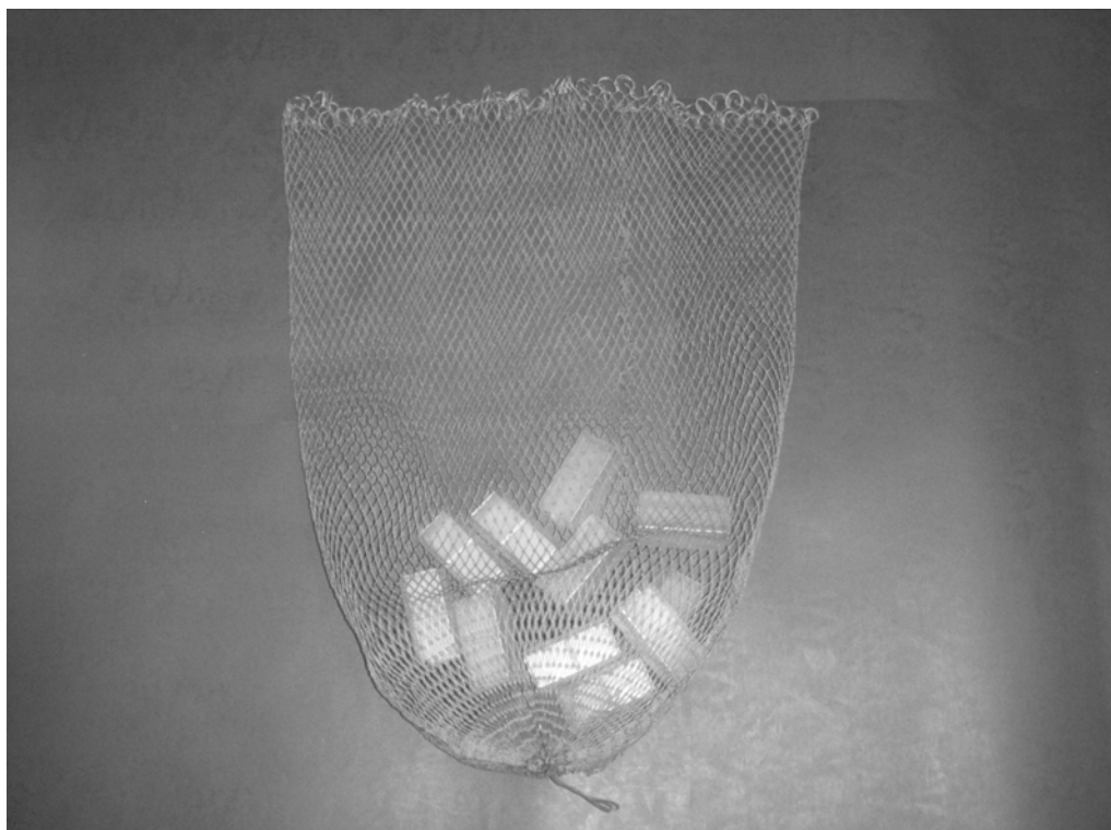
ภาพประกอบ 31 แสดงการบรรจุตัวกลางจากขวดพลาสติกเหลือใช้ลงในตาข่ายไนลอน
