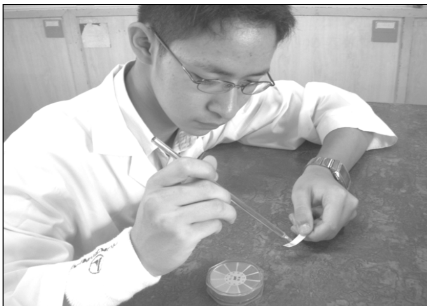
ภาพประกอบ 3 แสดงวิธีการตรวจวัดค่าความเป็นกรด-ด่างของน้ำโดยใช้กระดาษยูนิเวอร์ซัล อินดิเคเตอร์
