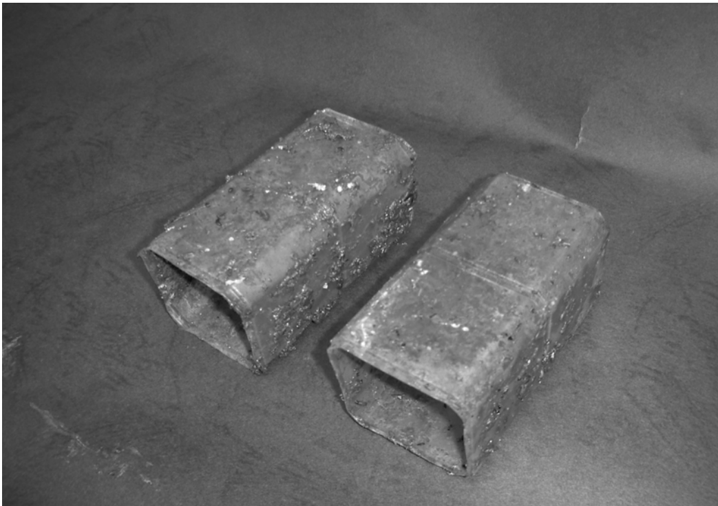
ภาพประกอบ 33 แสดงตัวกลางจากขวดพลาสติกเหลือใช้ภายในระบบบำบัดน้ำเสียแบบไม่ใช้ออกซิเจน
