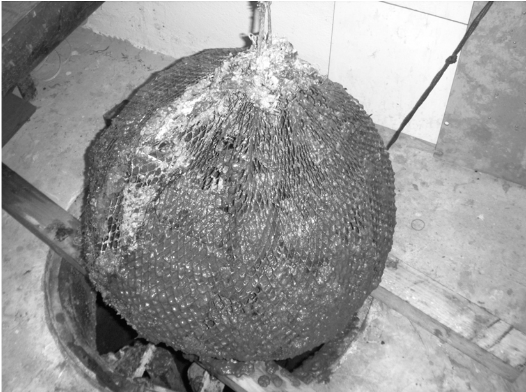
ภาพประกอบ 32 แสดงการนำตัวกลางออกจากถังหมักแบบไร้ออกซิเจน
