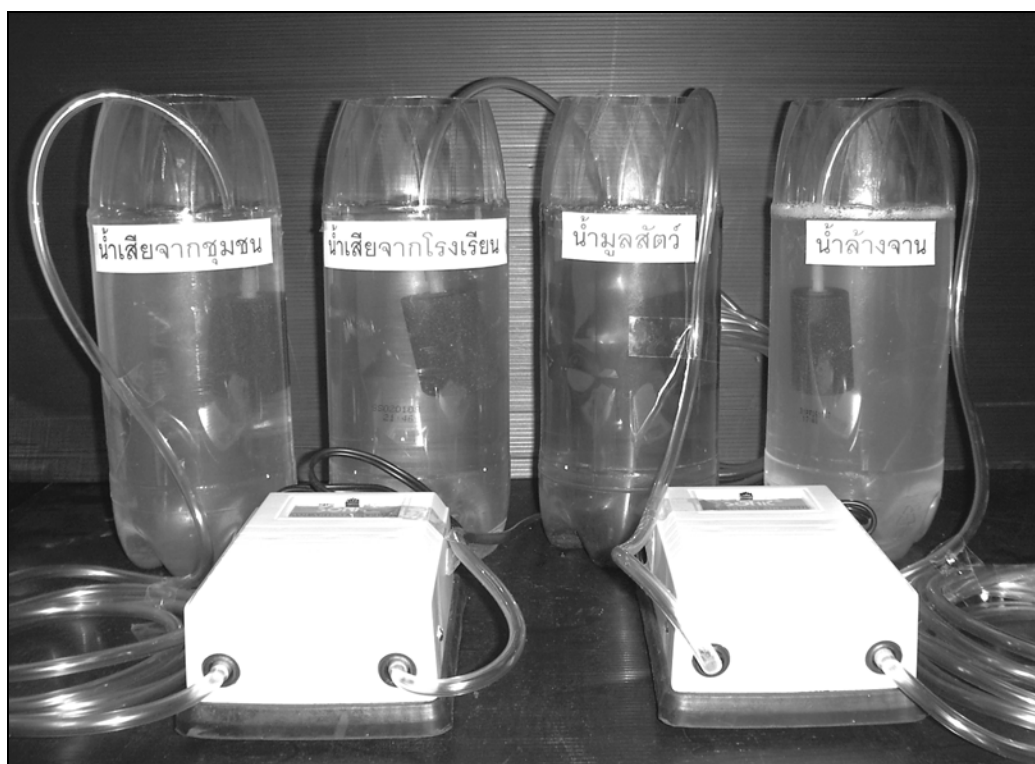
ภาพประกอบ 20 แสดงการบำบัดน้ำเสียด้วยวิธีการทางชีวภาพแบบใช้ออกซิเจน
