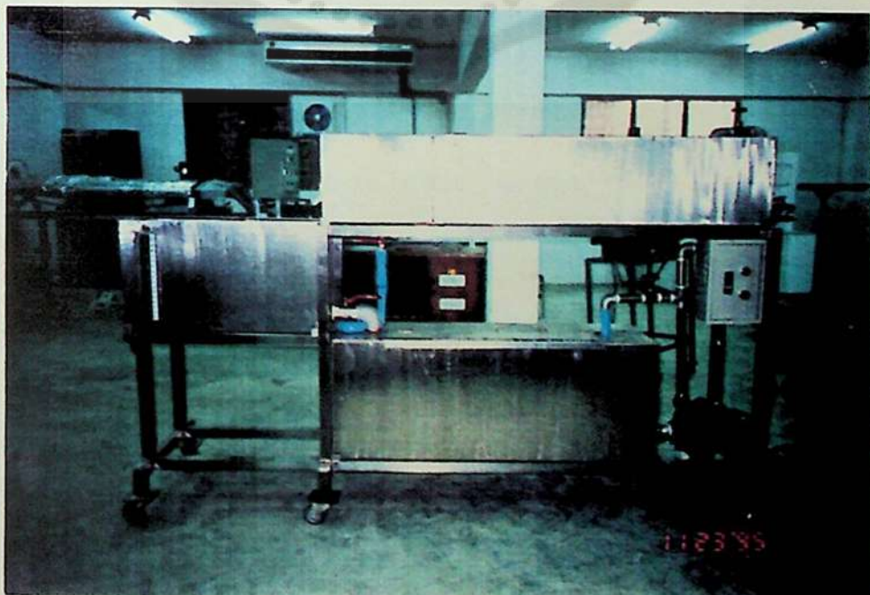
รูปที่ 3.5 ชุดทดลองการไหลในช่องทางเปิด
