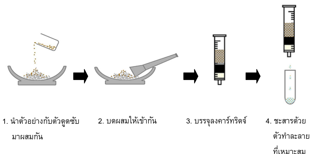
ภาพประกอบ 6 ขั้นตอนการสกัดแบบ matrix solid phase dispersion
