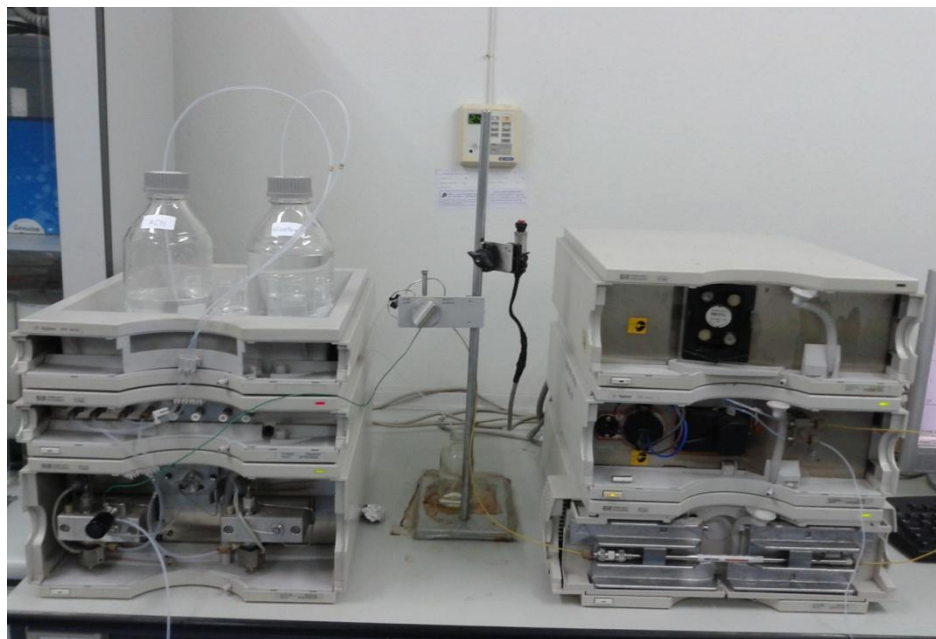
ภาพประกอบ 28 เครื่องโครมาโทกราฟีของเหลวสมรรถนะสูงและใช้ตัวตรวจวัดแบบไดโอดแอร์เรย์ (จากบริษัท Hewlett-Packard รุ่น HP 1100)
