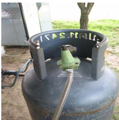
ภาพประกอบ 16 แสดงถังบรรจุแก๊สแอลพีจีและอุปกรณ์ปรับแรงดัน
