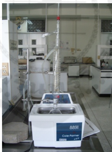
รูปที่ภาคผนวก จ6 การสกัดไขมันด้วยเครื่องอัลตราโซนิก
