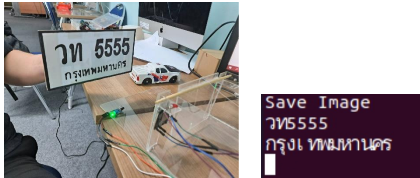
รูปที่ 20 ตัวอย่างการทดสอบการตรวจจับป้ายทะเบียน และผลลัพธ์บน Terminal
