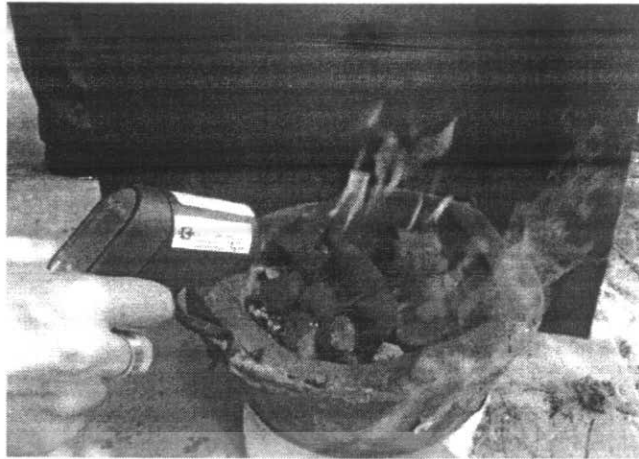
รูปที่ 4.19 การวัดอุณหภูมิขณะเผาไหม้ของแท่งเชื้อเพลิงแข็งจากกากเมล็ดสับดูดำ
