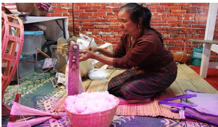
ภาพประกอบ 17 เครื่องอัดฝ้ายและการอัดฝ้าย
