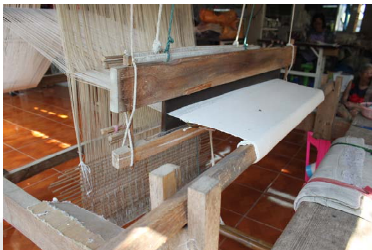
ภาพประกอบ 13 ตะกอล ตะกอลลอก และไม้กำพัน
