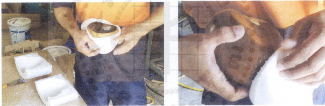
ภาพประกอบ 42 การถอดกะโหลกช่อู้ต้นแบบออกจากแม่แบบซิลิโคน
