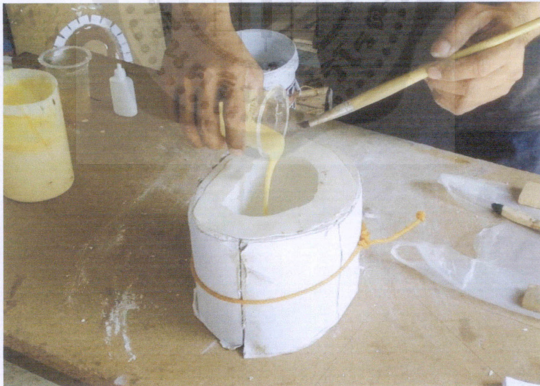
ภาพประกอบ 50 การเทเรซินลงในแม่แบบซิลิโคน
