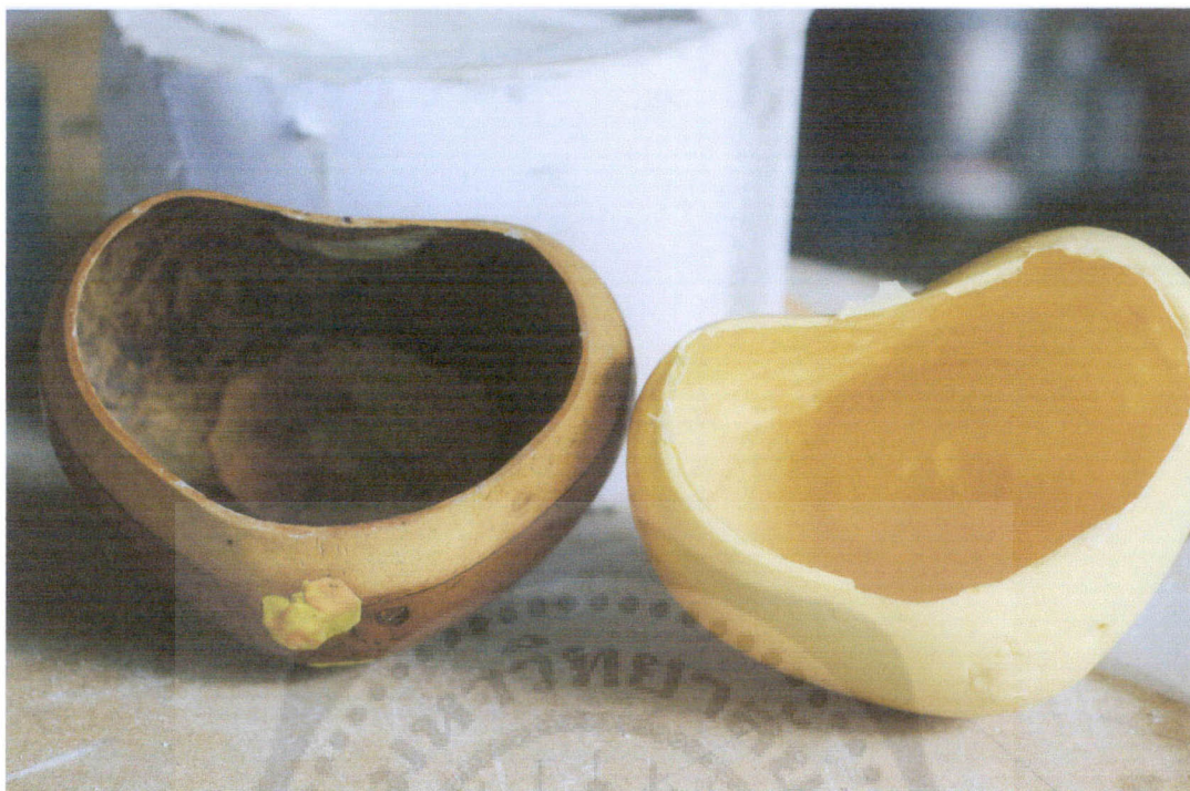
ภาพประกอบ 58 กะโหลกชอู้ต้นแบบ และกะโหลกชอู้ "ไฟเบอร์กลาส"
