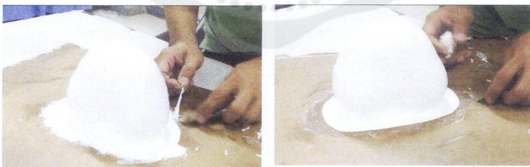
ภาพประกอบ 36 การตัดตกแต่งขอบชิ้นงานซิลิโคน
