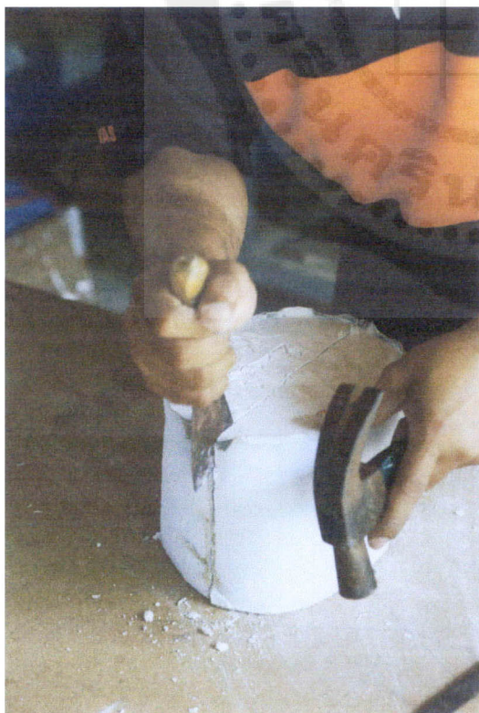
ภาพประกอบ 40 การใช้ค้อนและเกรียงตอกลงบนแม่แบบ
