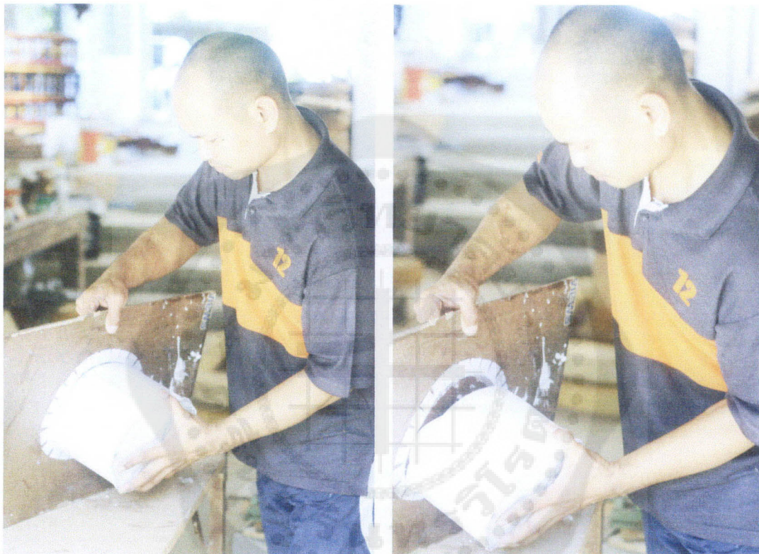
ภาพประกอบ 37 การถอดแม่แบบออกจากแผ่นไม้รองชิ้นงาน
