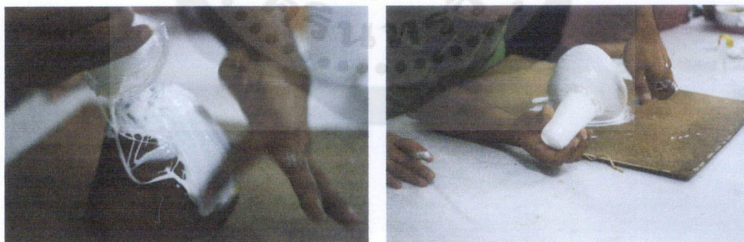
ภาพประกอบ 34 การทำซิลิโคนลงบนกะโหลกขوذัดต้นแบบ
