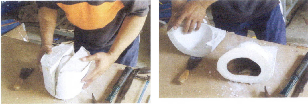
ภาพประกอบ 41 แม่แบบปูนพลาสติกที่แบ่งออกจากกันเป็นสองส่วน
