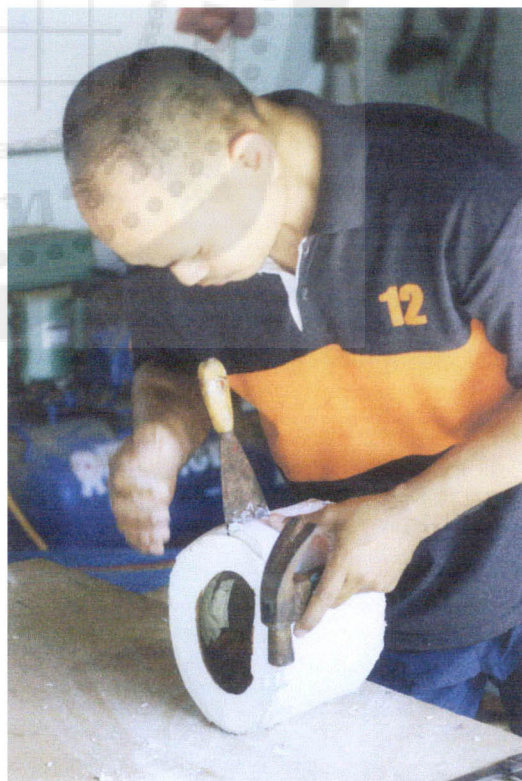
ภาพประกอบ 40 การใช้ค้อนและเกรียงตอกลงบนแม่แบบ
