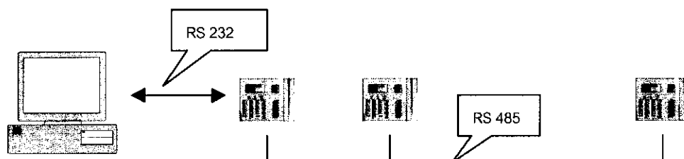
ภาพประกอบ 11 ระบบเครื่องควบคุมประตู (Access Control Unit /ACCU)
