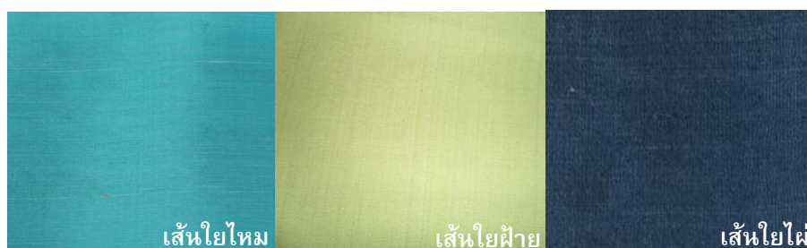
ภาพประกอบ 35 การเปรียบเทียบลักษณะการทอผ้าพื้นของเส้นใยไหม เส้นใยฝ้าย และเส้นใยไผ่
