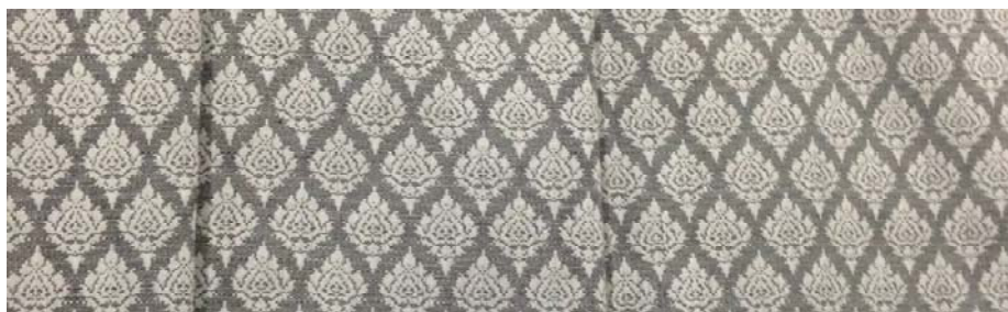
ภาพประกอบ 38 ลักษณะการทอผ้ายกดอกโดยใช้เส้นใยไหมเป็นเส้นยืนและเส้นใยฝ้ายเป็นเส้นพุ่ง
